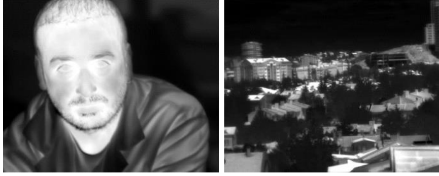
Görsel 2.12. 640x512 dizimli pBin T2SL FPA'nın MWIR dalgaboyu görüntüleri [54]
