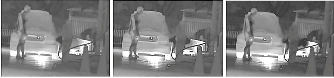
Görsel 2.11. 320x256 FPA dedektörüyle metan gazı tespiti anı [53]
