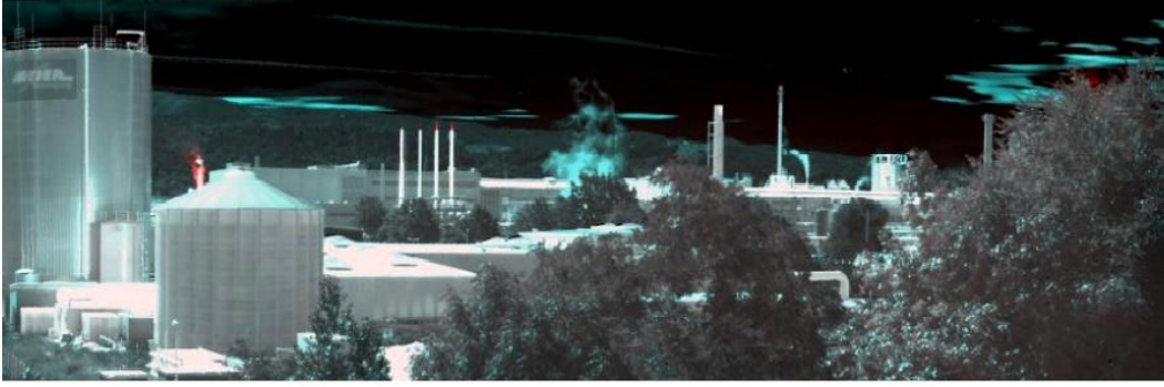
Görsel 2.15. Bir sanayi sitesinin 384x288 çift renkli InAs/GaSb SL kamerayla çekilmiş bispektral kızılötesi görüntüsü [58]
