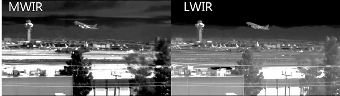
Görsel 2.16. 80 K de F/4 optikli MWIR/LWIR çift bantlı dedektörden elde edilen termal görüntü [59]
