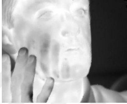
Görsel 2.7. 77 K de 320x256 InAs/GaSb T2SL nBn termal görüntü [49]
