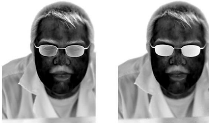
Görsel 2.14. Soldaki 3-4 \mu\text{m} mavi ve sağdaki 4-5 \mu\text{m} kırmızı kanal da termal görüntü [57]
