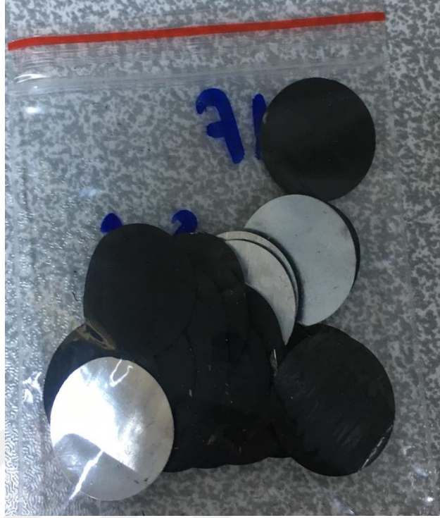
Şekil 2.7. Preslediğimiz malzemenin disk kesme makinesi ile kesilmesi
