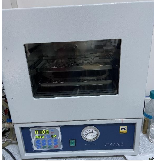
Şekil 2.3. Bolmiling den çıkardığımız malzemenin vakumlu etüvde kurutma
