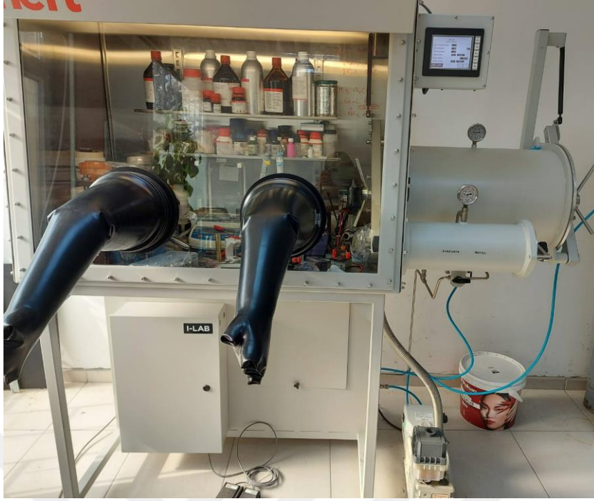
Şekil 2.8. İçerisinde argon gazı bulunan glove-box
