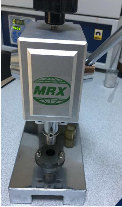
Şekil 2.7. Preslediğimiz malzemenin disk kesme makinesi ile kesilmesi
