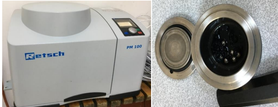
Şekil 2. 2. Soldaki bilyeli değirmen ve sağdaki alkol ve carbon black karışımı
