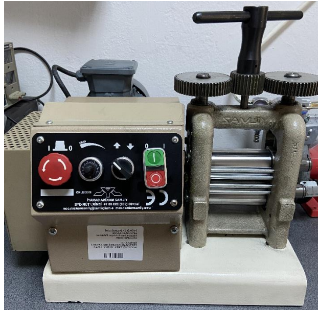
Şekil 2.6. Alüminyum folyo üzerindeki katotun preslenmesi
