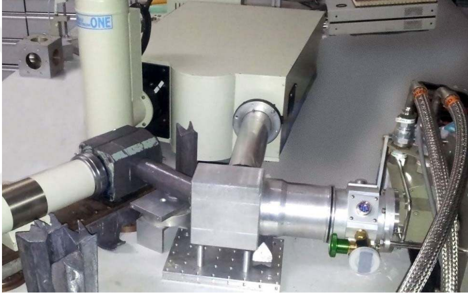
Şekil 3.2. X-ışını ölçümlerinin yapıldığı sistem.
