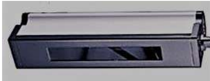
Şekil 3.4. UVP marka 3u838 modeli UV radyasyon kaynağı.
