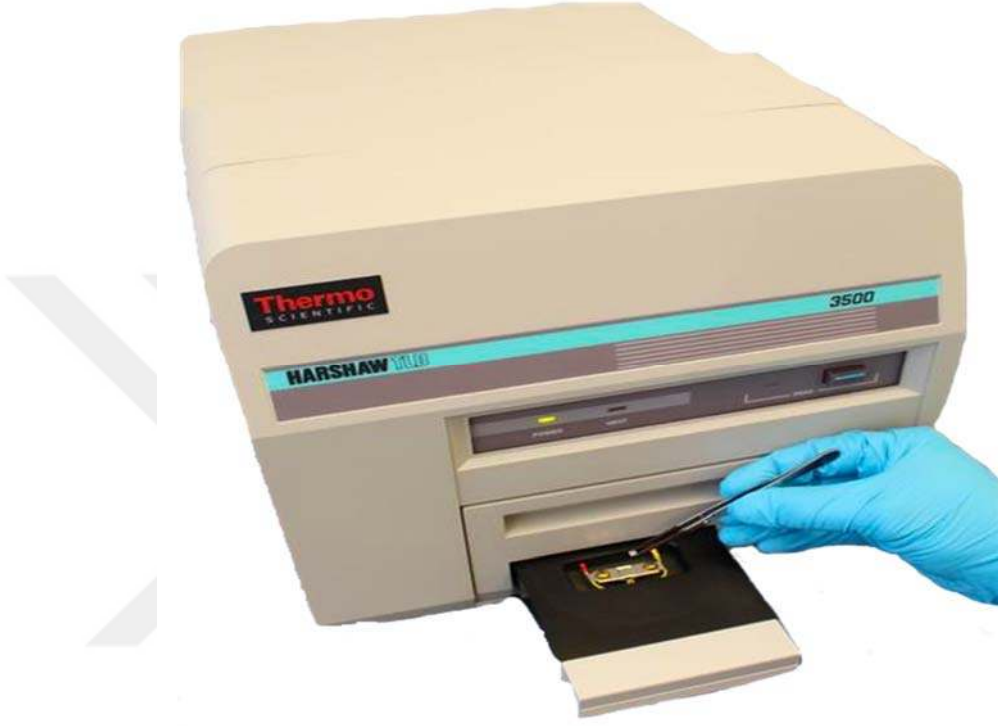
Şekil 3.3. Harshaw 3500 termoluminesans dozimetre okuyucu sistem.
