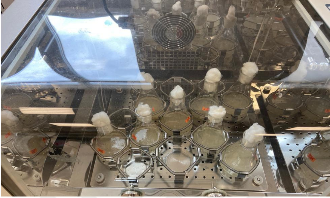
Şekil 2.4. Islak peletlerin eklendiği uygulama ortamlarının çalkalayıcı inkübatöre alınması
