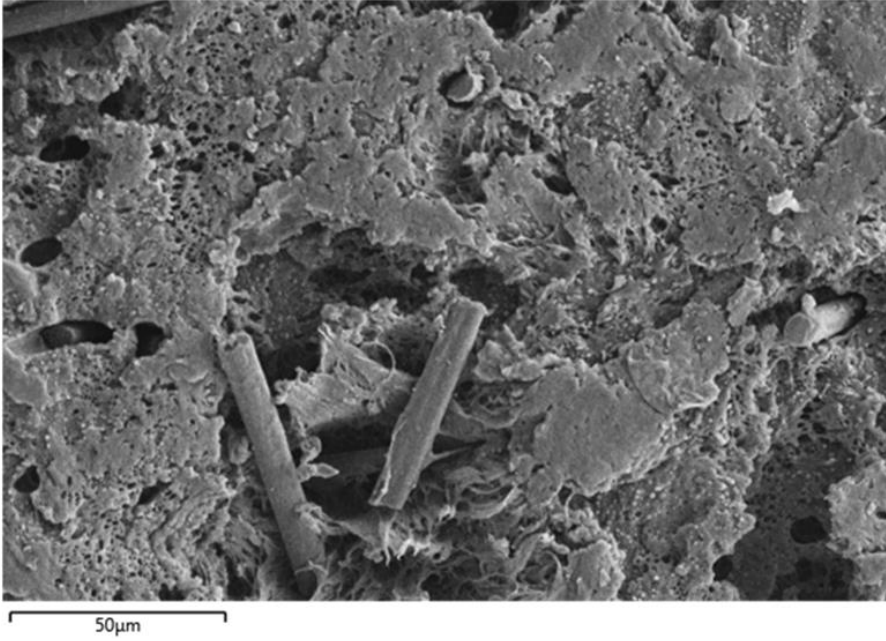
Şekil 6.17. Çekme testi sonrası NM4 numunesine ait hasarlı kesitin SEM görüntüsü
