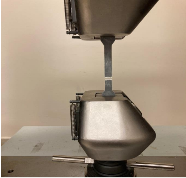
Resim 5.5. Shimadzu AG-IC ile gerçekleştirilen çekme deneyi
