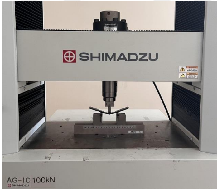
Resim 5.6. Shimadzu AG-IC test cihazı ile gerçekleştirilen üç nokta eğilme deneyi
