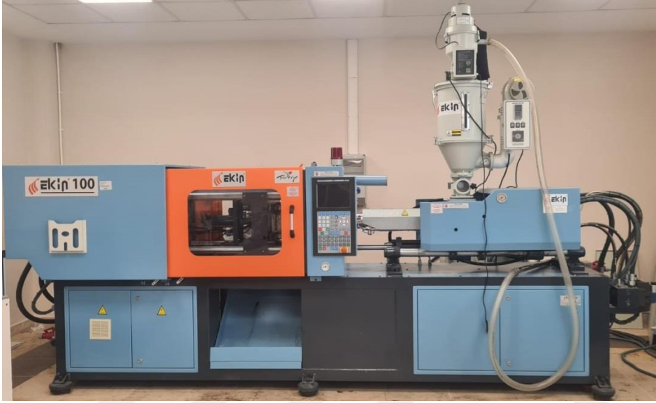
Resim 5.4. Ekin 100 plastik enjeksiyon makinesi
