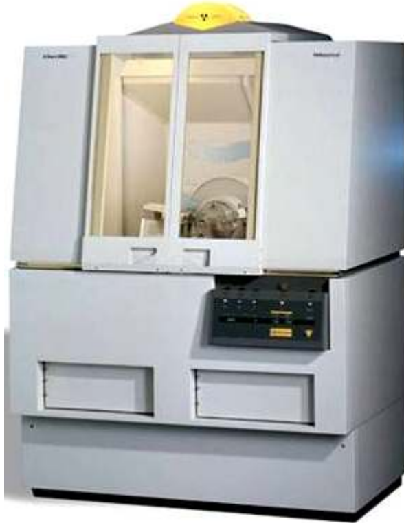
Şekil 6.9. Philips Expert Pro X-ışını kırınım ölçer sistemi [48].
