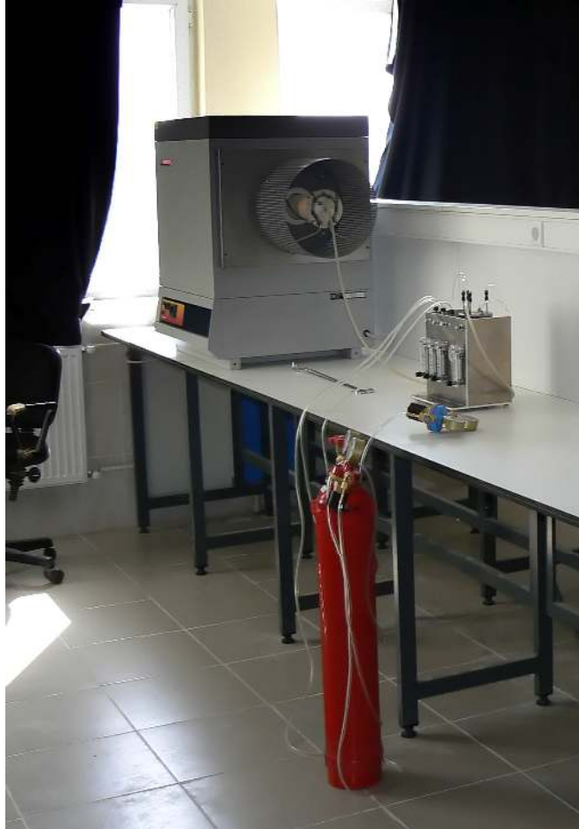
Şekil 6.1. Gaz karıştırma sistemi, buna bağlı H 2 gazı tüpü ve yüksek sıcaklık fırını.
