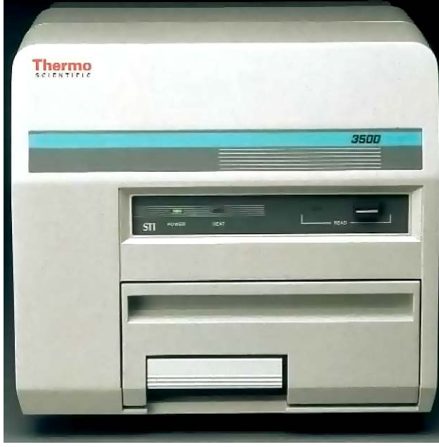
Şekil 6.15. Harshaw 3500 TLD okuyucu sistem [53].
