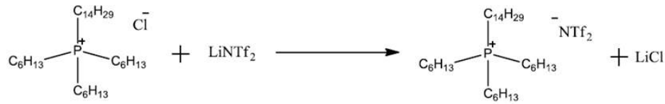
Şekil 8.8. [P_{666(14)}][NTf_2] sentez reaksiyonu.
