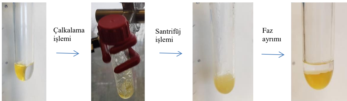
Şekil 8.10. Sıvı - sıvı ekstraksiyon prosesinin aşamaları.
