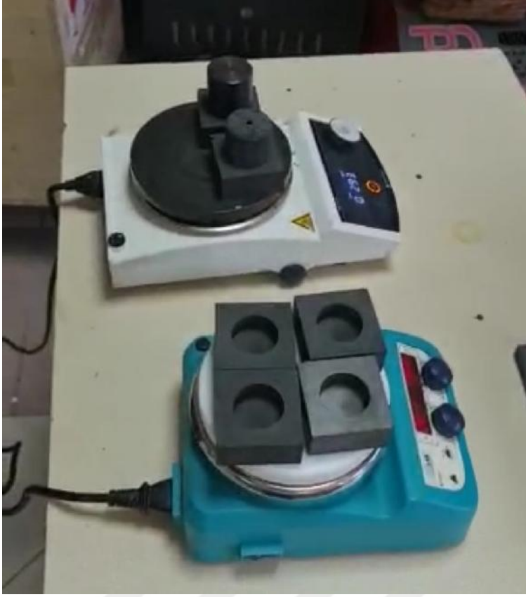
Şekil 4.2 Cam eriyiğin şekillendirme işlemi
