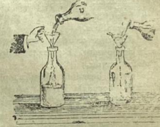
(R. 5) - Huninin yanlarından şişenin içindeki hava çıkmazsa, su kolayca akmaz.
