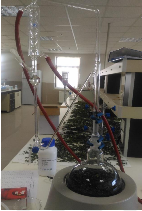
Şekil 3.5. Su destilasyonu deney düzeneği
