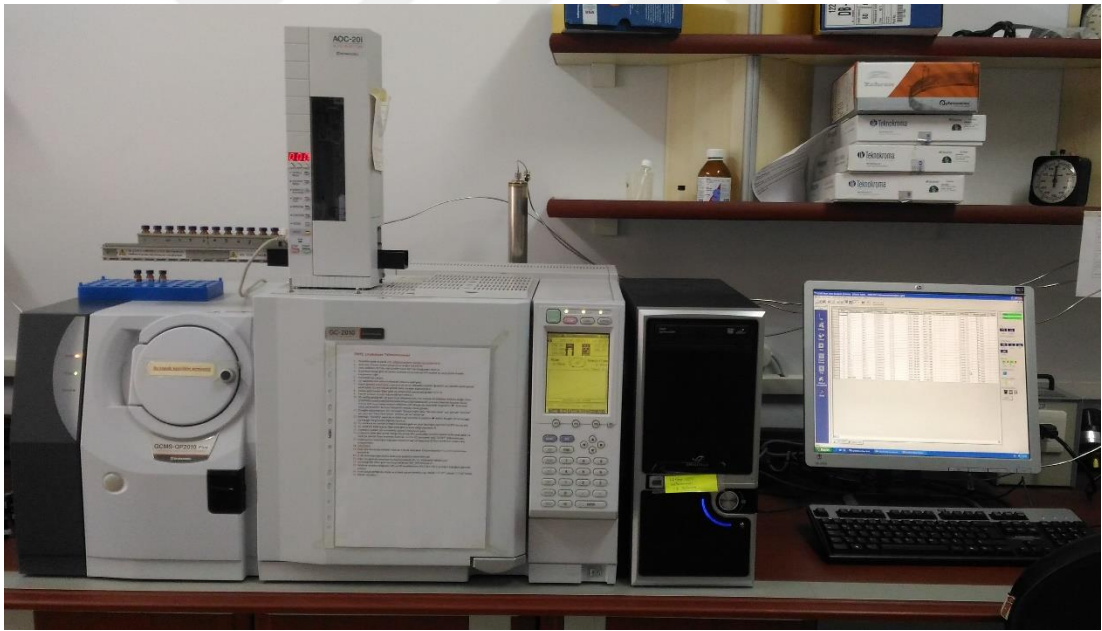
Şekil 3.2. Shimadzu 2010 marka Gaz kromatografi - Kütle spektrometre (GC–MS) cihazı
