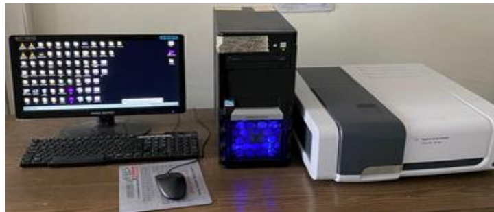
Şekil 4.3. Ultraviyole Görünür Bölge Spektroskopisi (UV-Vis) cihazı görünümü
