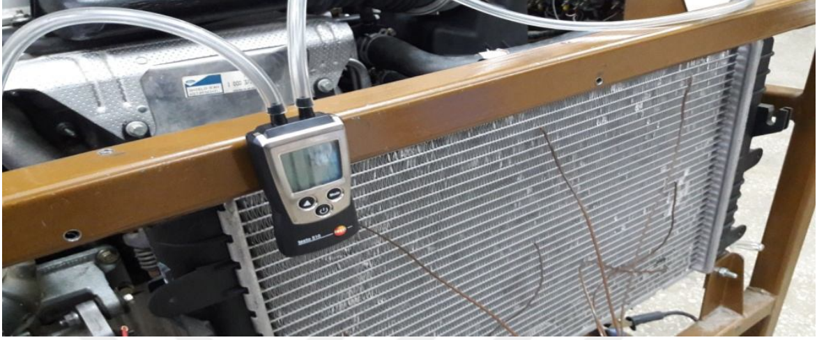
Şekil 2.11. Testo 510 basınç ölçer cihazının bağlantı şekli
