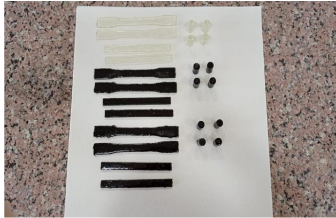
Resim 3.13 Kalıplanan numune görüntüsü (GO, Polyester).
