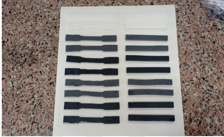
Resim 3.12 Kalıplanan numune görüntüsü (GO,rGO,Silikon).
