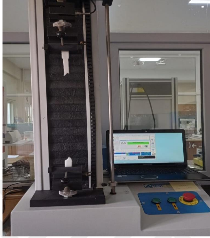
Resim 4.3 Çekme testi örneği (saf silikon kopmuş hali).
