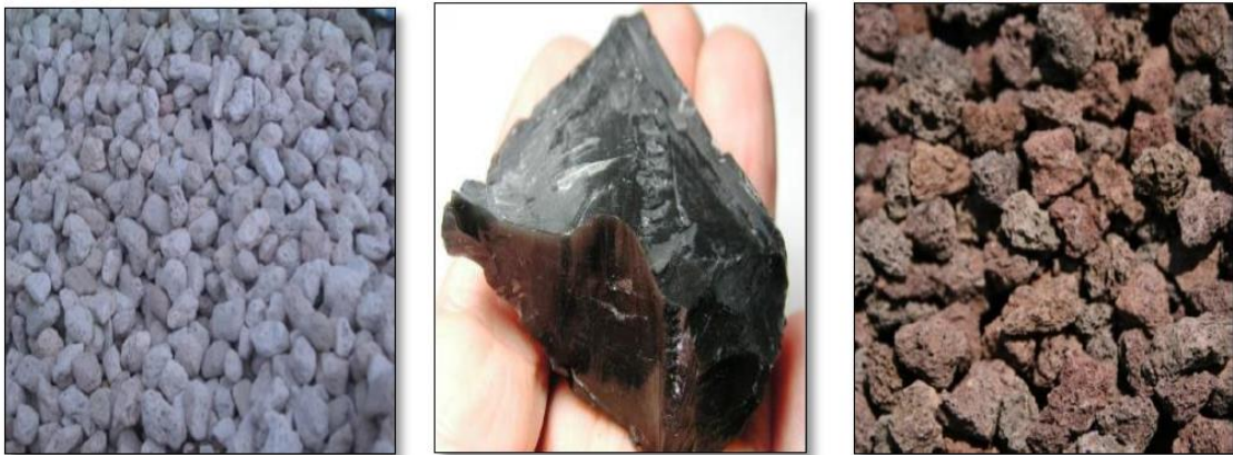
Şekil 2.7. Volkanik orijinli doğal puzolanlar; pomza, volkanik cam ve tuf (Akgül,2006)
