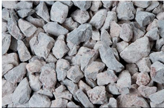
Şekil 2.11. Agrega olarak kullanılan havada soğutulmuş cüruf (Ulugöl, 2015)
