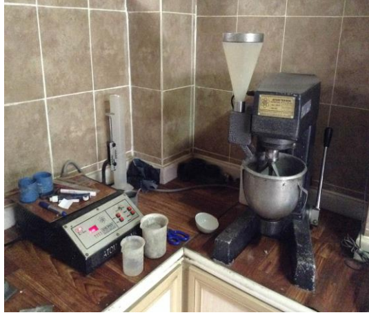
Şekil 3.9. 5 litre kapasiteli karıştırıcı (Mikser)
