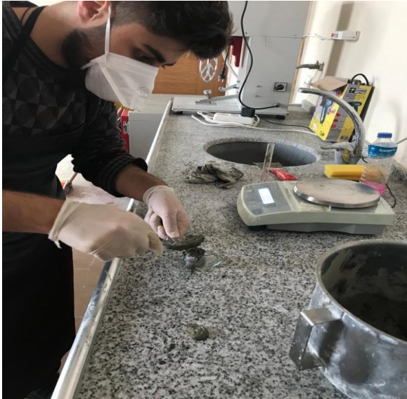
a) Harcın hazırlanması ve kalıplara aktarılması
