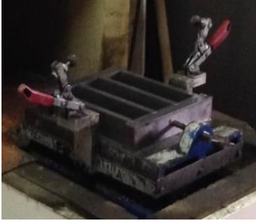
a) 40 x 40 x 160 mm prizma şekilli kalıp
