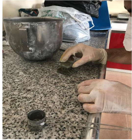
b) Kalıbın yüzeylerinin cam plakayla kapatılması
