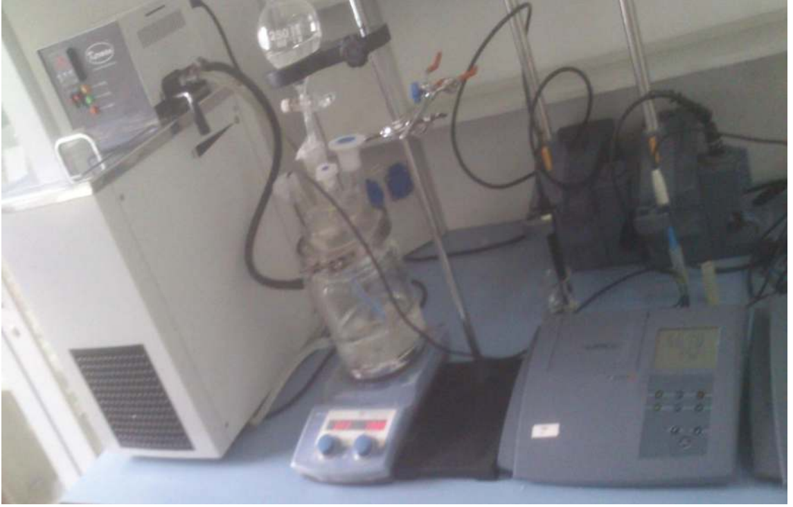
Şekil 5. 2 Baryum sülfat kristalizasyon deney düzeneği
