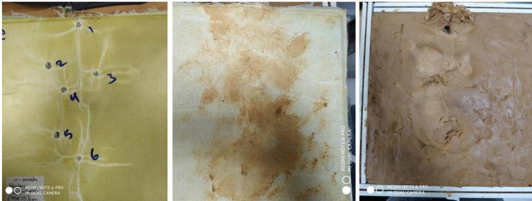
Şekil 4.78: Balistik atış sonrası kevlar plakanın yüzeyleri ile macun yüzeyi
