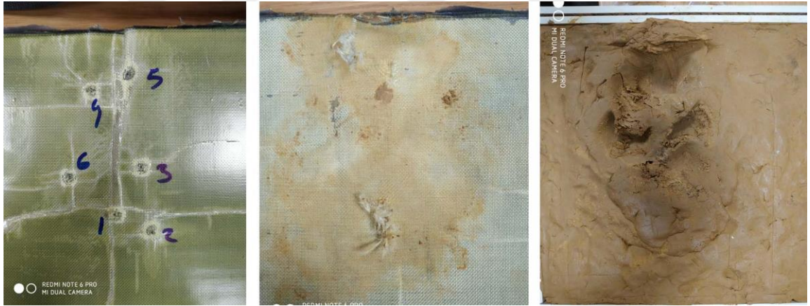
Şekil 4.79: Balistik atış sonrası % 0.2 oranında G katkılı kevlar plakanın ön ve arka yüzü ile yerleştirilen macun yüzeyi
