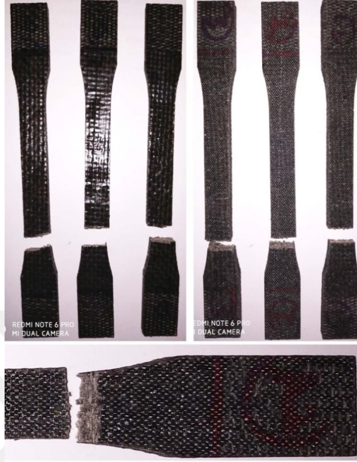
Şekil 4.22: % 0.2 oranında grafen katkılı jüt kompozitte oluşan hasarlar
