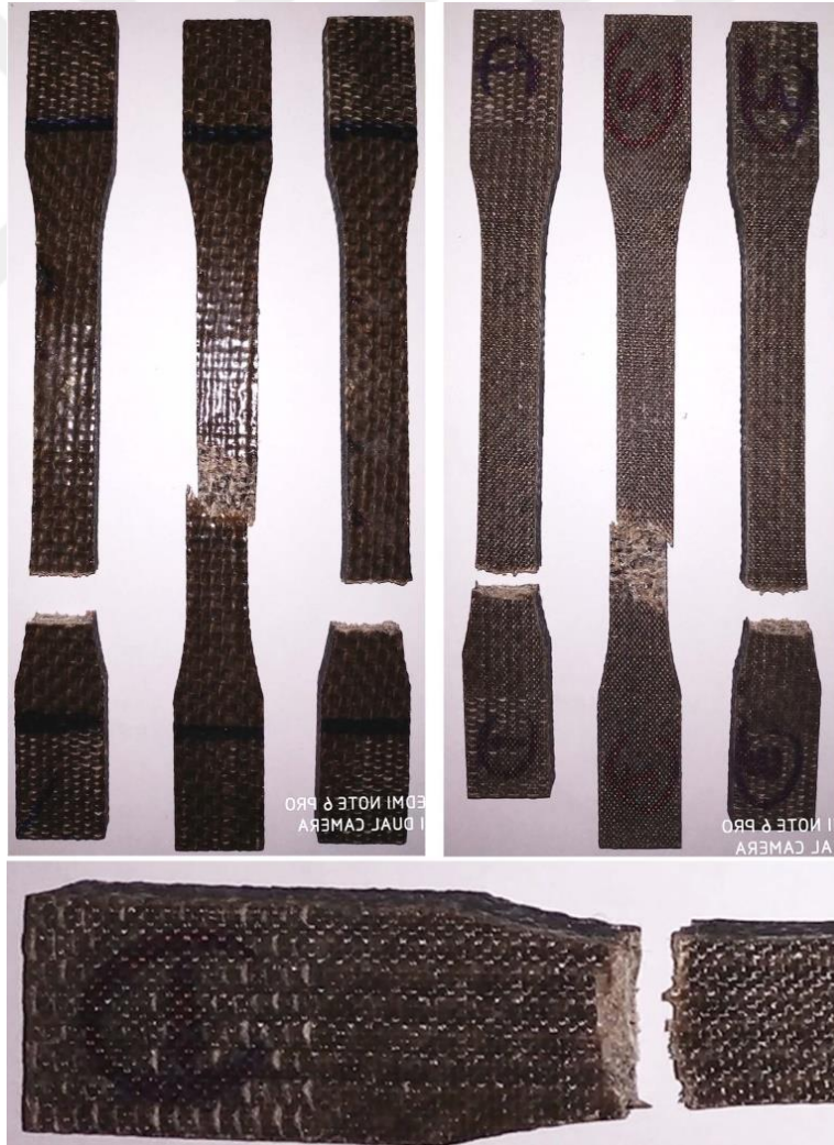
Şekil 4.19: Jüt kompozitte oluşan hasarlar
