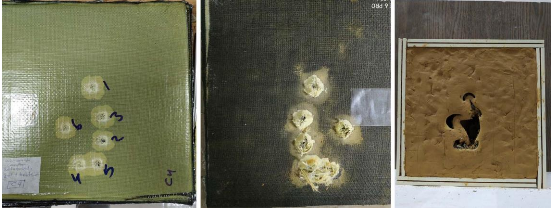
Şekil 4.80: Balistik atış sonrası % 0.2 oranında G katkılı jüt+keklar plakanın ön ve arka yüzü ile yerleştirilen macun yüzeyi
