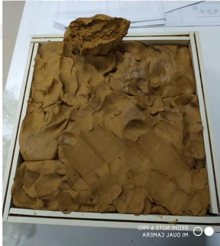
Şekil 4.76: Test tezgahına macun yerleştirilmesi
