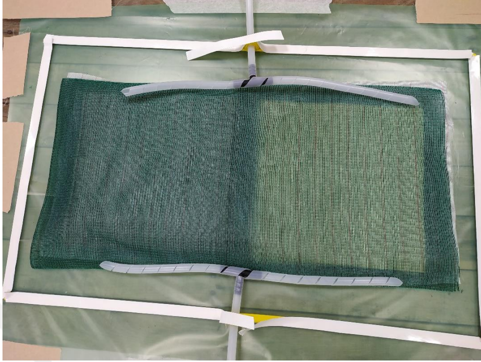
Şekil 3.5: Vakum infüzyon yöntemi için numune hazırlama
