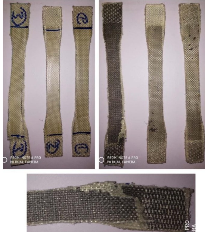
Şekil 4.23: % 0.2 oranında grafen katkılı kevlar kompozitte oluşan hasarlar
