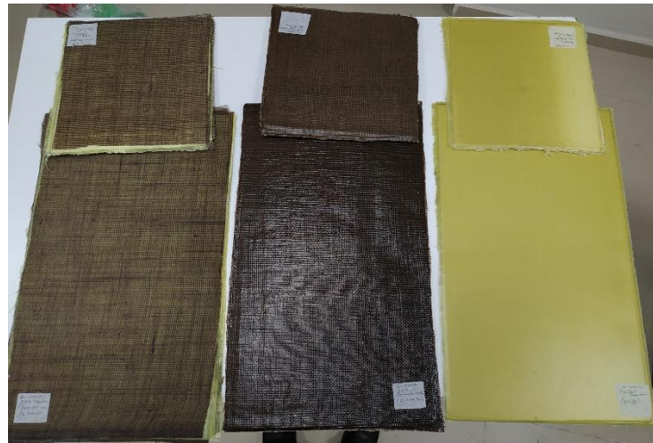
Şekil 3.14: Üretilen kompozit plakalar ( jüt+Kevlar, jüt ve kevlar)
