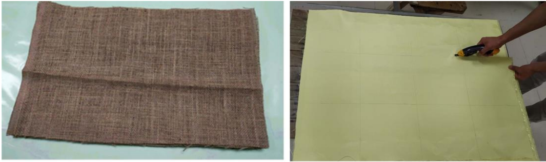
Şekil 3.2: 300x500 mm'lik boyutunda kesilen kevlar ve jüt kumaşları
