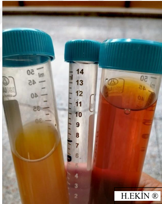
Şekil 3.4. Soldan sağa zencefil sulu ekstresi, gümüş nitrat çözeltisi ve ekstrakt ile karıştırıldığında 24 saat sonra gümüş-nano partikül (AgNP)'lerin oluşumu ile elde edilen kahverengi- turuncu renkli çözelti
