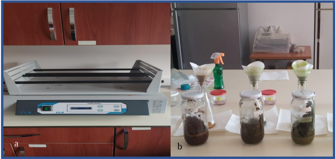
Şekil 3.2. a) Orbital çalkalayıcı b) Bitki ekstraktının filtre kağıdından geçirilmesi
