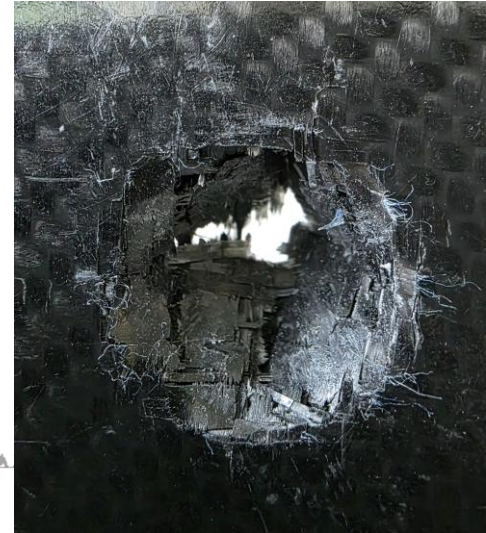
Şekil 7.22 a) 70 J darbe enerjisinde % 1,75 bor karbür katkılı hibrit numunenin kuvvet-çökme grafiği b) Numunenin ön yüzünün fotoğrafı
