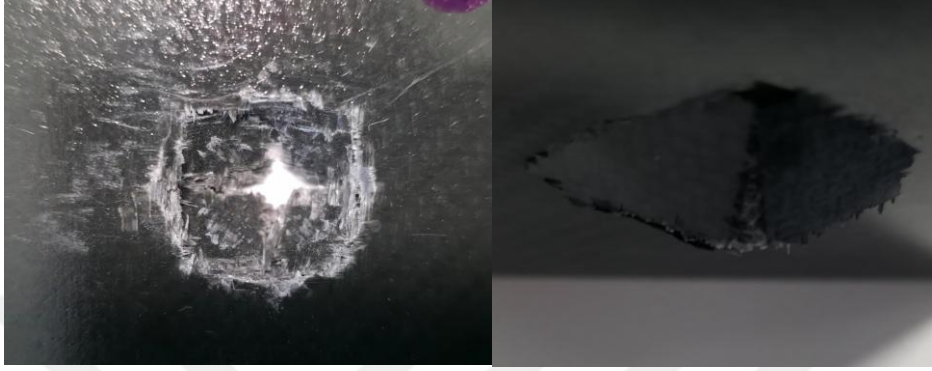
a) 30 J darbe enerjisinde hibrit numunenin ön ve arka yüzü
