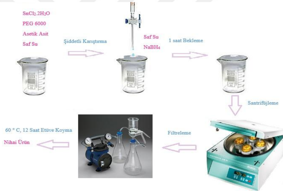
Şekil 4.1. Sn nano tozlarının üretim şeması.
