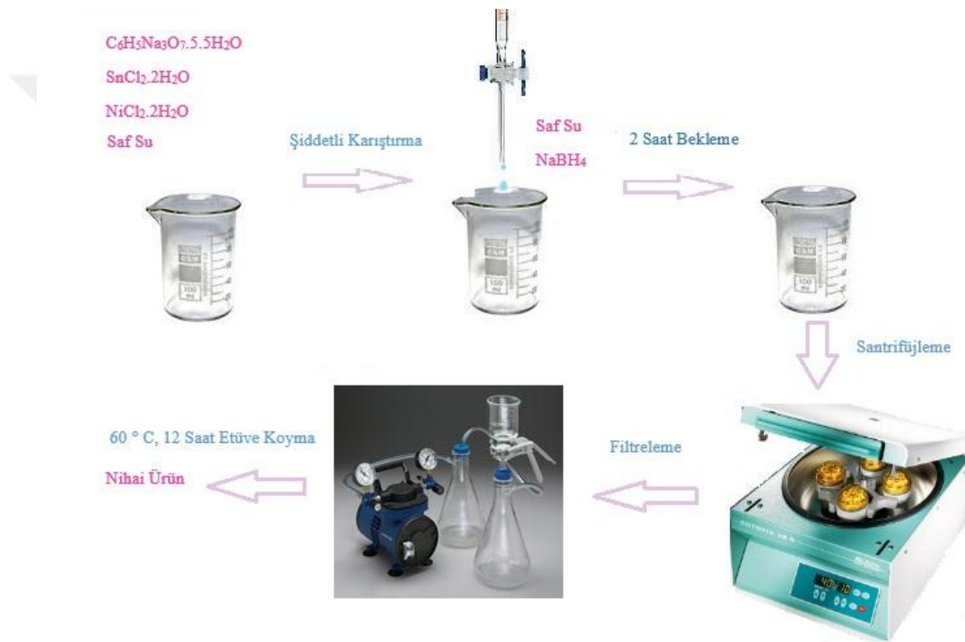
Şekil 4.2. \text{Ni}_3\text{Sn}_4 intermetalik nano tozlarının üretim şeması.
