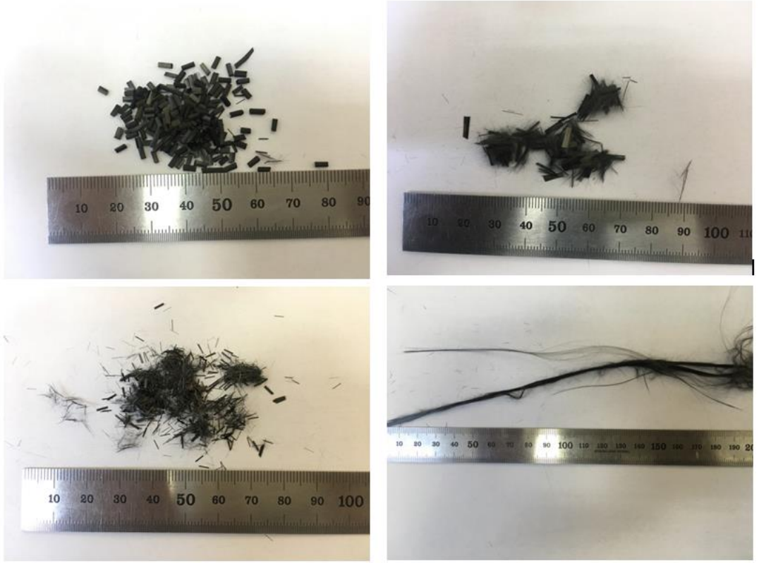
Şekil 2.13 Karbon lif a) Pellet(kaplamalı) 3mm b) lif(kaplamasız) 5 mm c) lif(kaplamasız) 3 mm d) lif kesilmemiş uzun hali (Kişisel arşiv, 2017)
