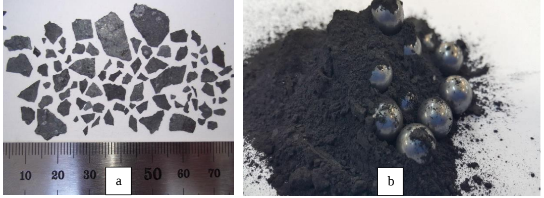
Şekil 2.5 a) Tufal b) Öğütülmüş tufal (Teomete, 2017)
