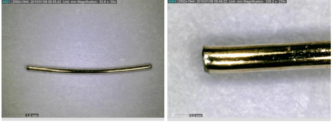
Şekil 2.9 Pirinç kaplı 6mm çelik lif a) 50 kat büyütme b) 235 kat büyütme (Teomete, 2017)
