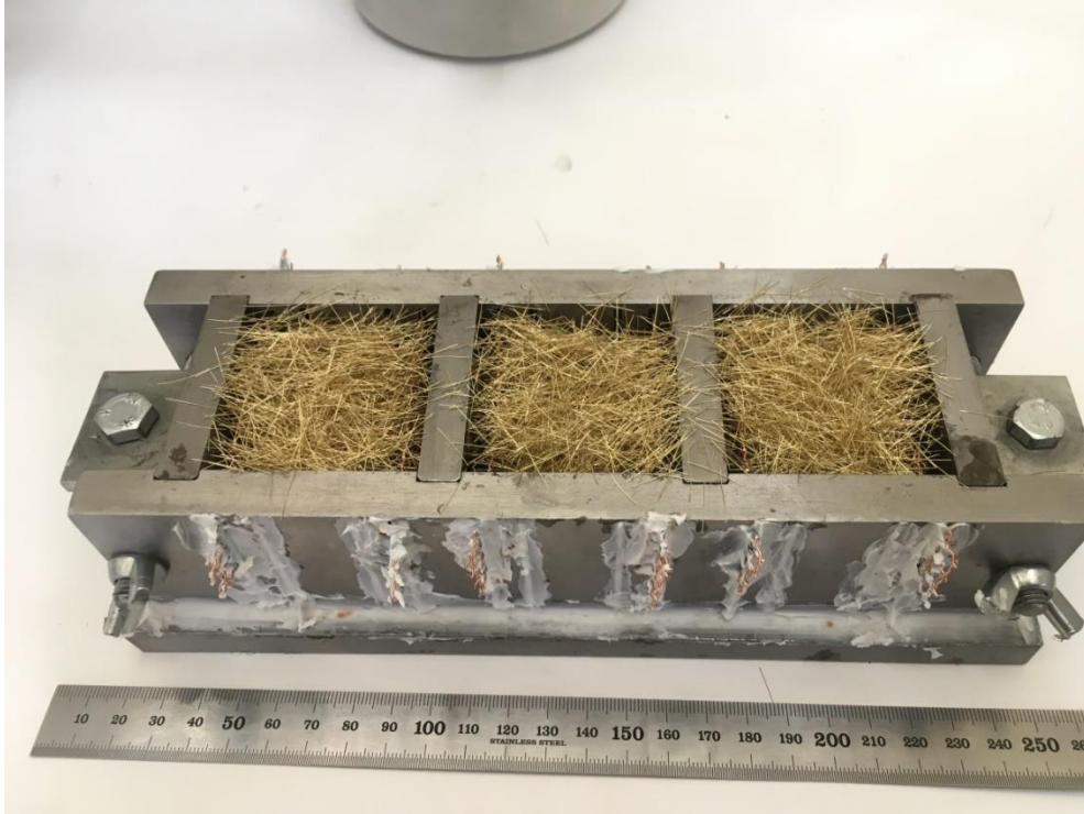
Şekil 2.26 SIFCON Döküm kalıbı (Kişisel arşiv, 2017)
