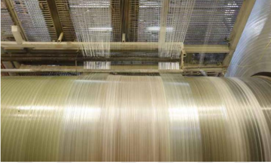
Şekil 2.3. Elyaf sarma yöntemi ile üretilmiş cam elyaf takviyeli boru [20].
