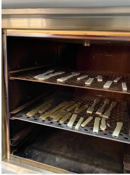
Şekil 3.8. Etüvde post kür işlemi.
