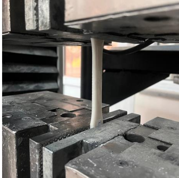
Şekil 4.8. Çekme testi yapılan %2 \text{ZrO}_2 katkılı numune.
