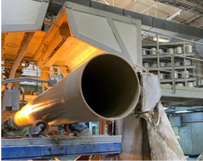
Şekil 3.16. SiO 2 katkılı boru üretimi.
