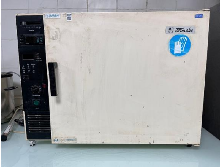
Şekil 3.9. Post kürleme işleminde kullanılan Termaks marka etüv.
