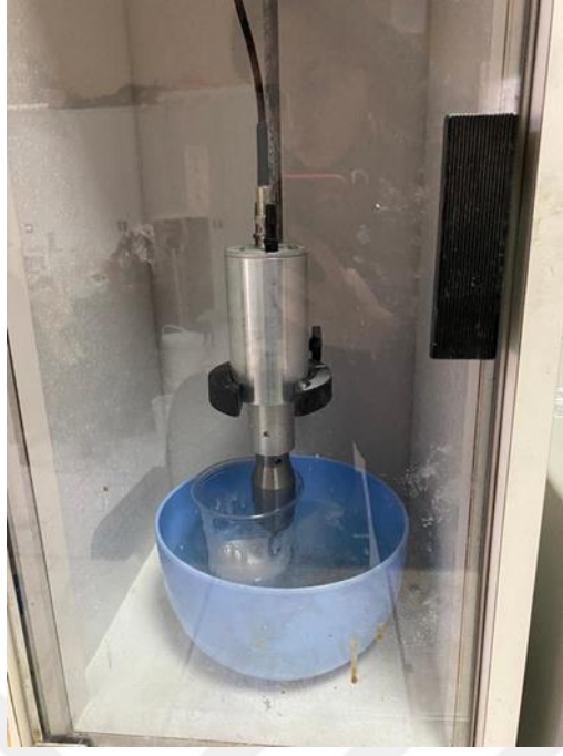
Şekil 3.4. Ultrasonik karıştırıcıda karıştırma işlemi (Sonics VC750).
