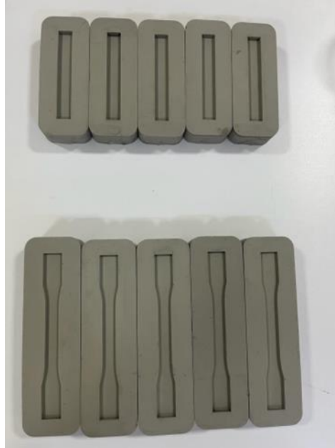
Şekil 3.5. Standartlara göre hazırlanmış silikon kalıplar.
