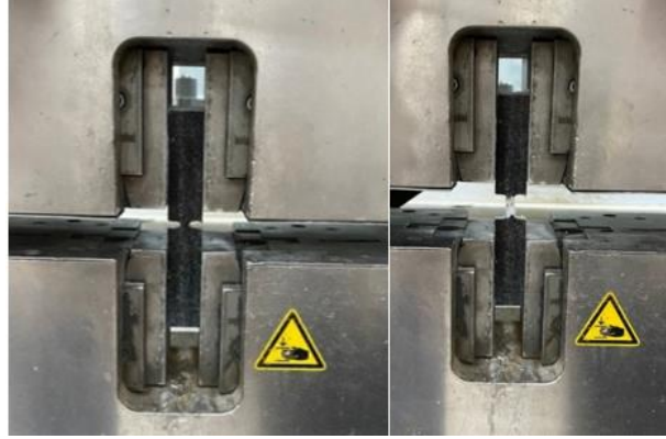
Şekil 4.27. Karbon nanotüp katkılı boru çember çekme dayanım testi.
