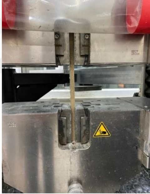
Şekil 4.31. Nano SiO 2 katkılı boru eksenel çekme dayanım testi.
