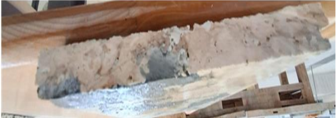
Resim 4. 4 Gri çimento dolgulu işlenmiş deney örneklerinin yüzeyleri
