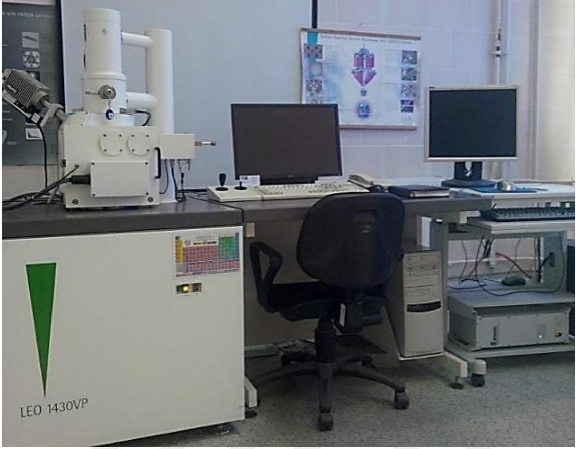
Resim 3. 8 Leo 1430 Vp SEM analiz cihazı (AKÜ-TUAM)
