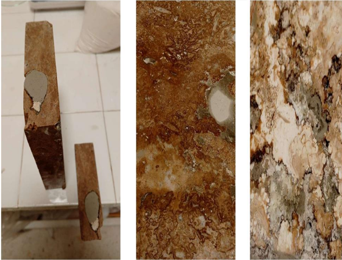
Resim 4. 1 Gri çimentolu dolgu harcının deney örneklerine uygulanması
