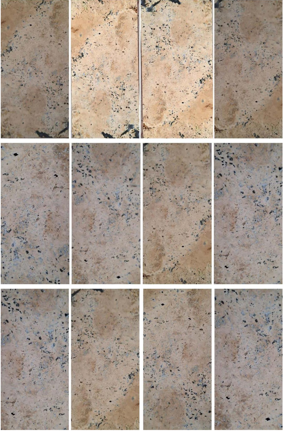
Resim 4. 6 Gri çimento dolgulu cilalanmış deney örnekleri
