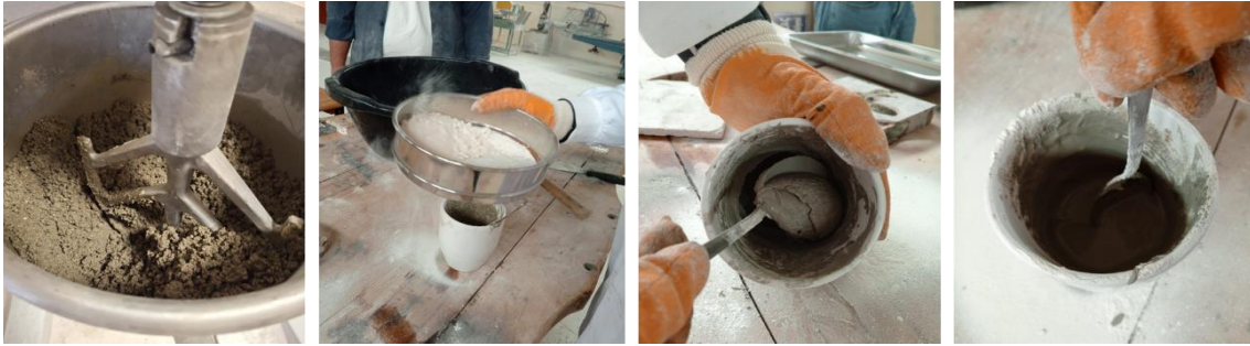
Resim 3. 2 Dolgu harcı karışımlarının hazırlanması
