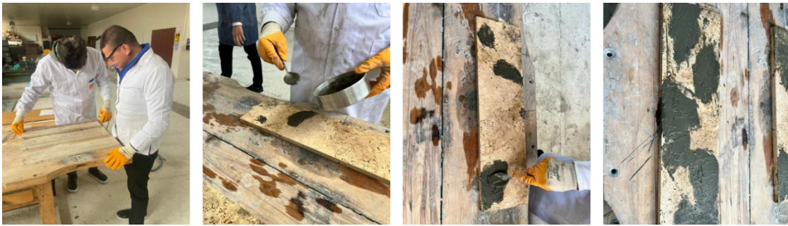
Resim 3. 3 Dolgu harcı karışımlarının deney örneklerine uygulanması
