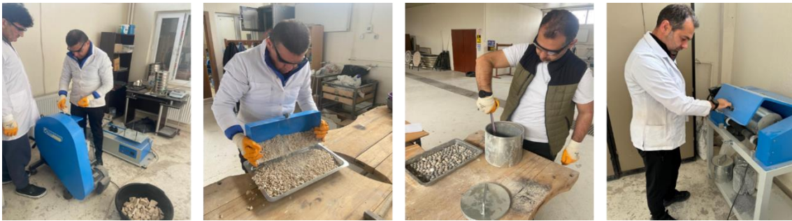
Resim 3. 1 Kırma ve öğütme işlemlerinin yapılması
