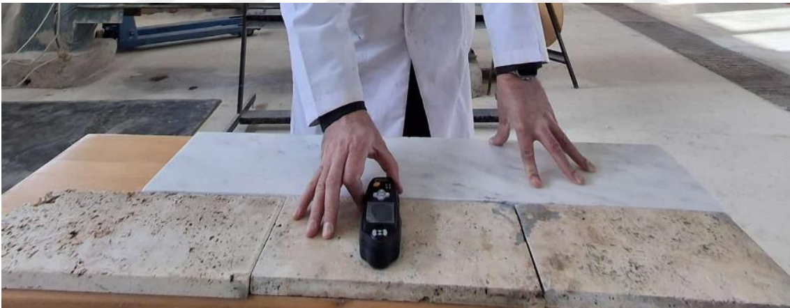
Resim 3. 12 Renk ölçümlerinin yapılması
