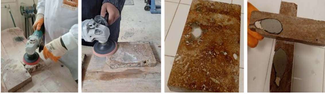
Resim 3. 4 Dolgu harcı uygulanmış deney örneklerinde yüzey düzeltilmesi
