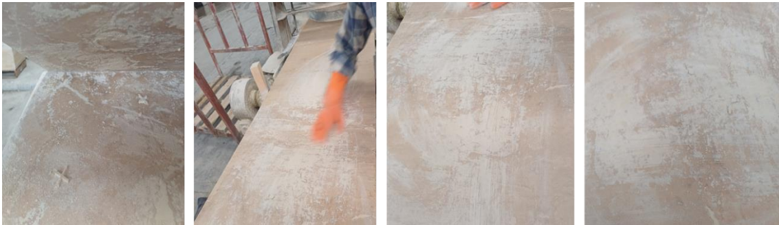
Resim 3. 6 Dolgu işlemi tamamlanan deney örneklerinin düzeltilmesi
