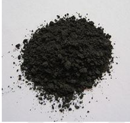
Şekil 3.14 Zirkonyum karbür nano-parçacıklar (ZrC)
