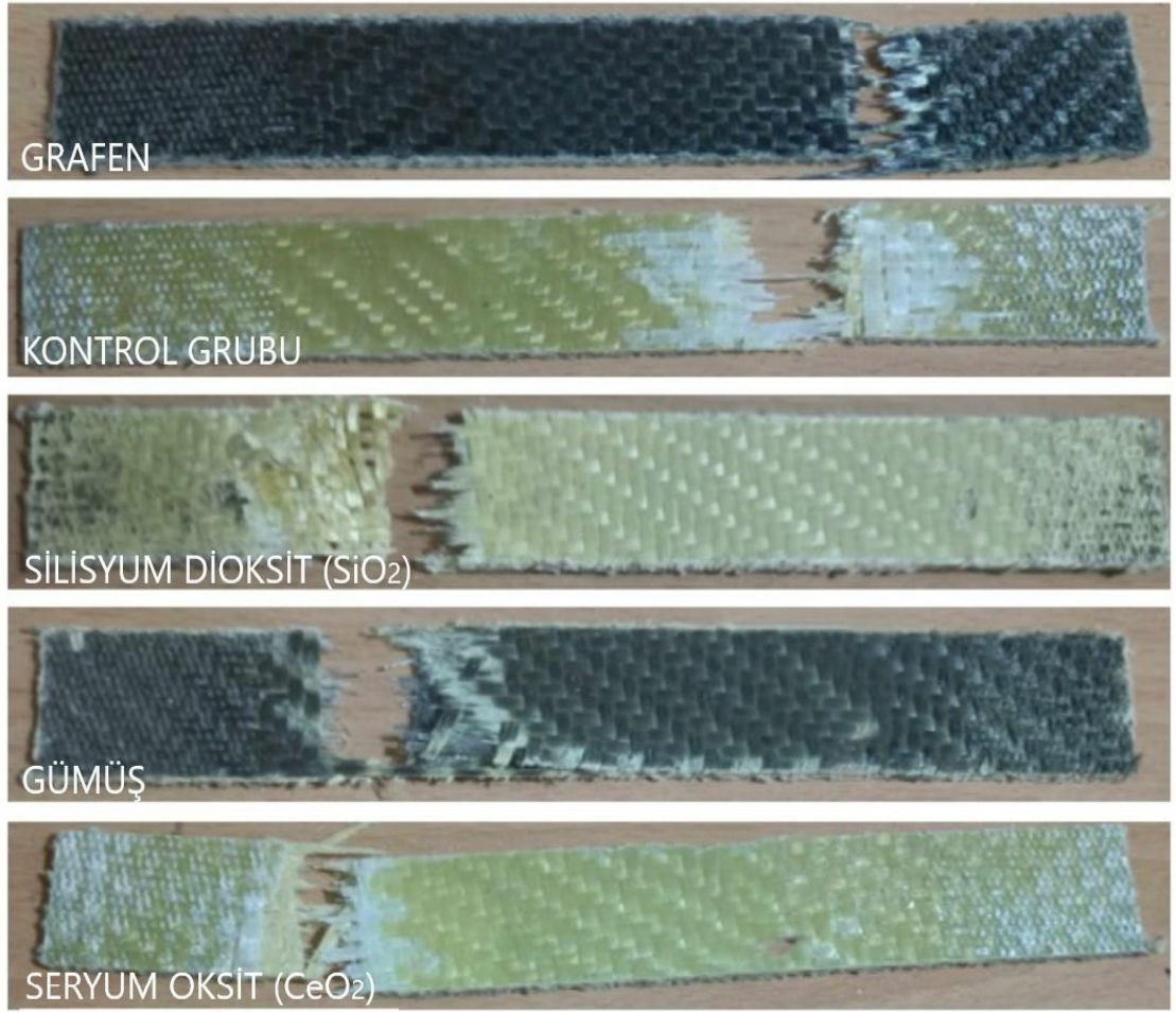
Şekil 21. Grafen, kontrol grubu, SiO 2 , gümüş ve seryum oksit ilave nano partikül katkıli kompozitlerin çekme deneyi numuneleri hasar görüntüleri
