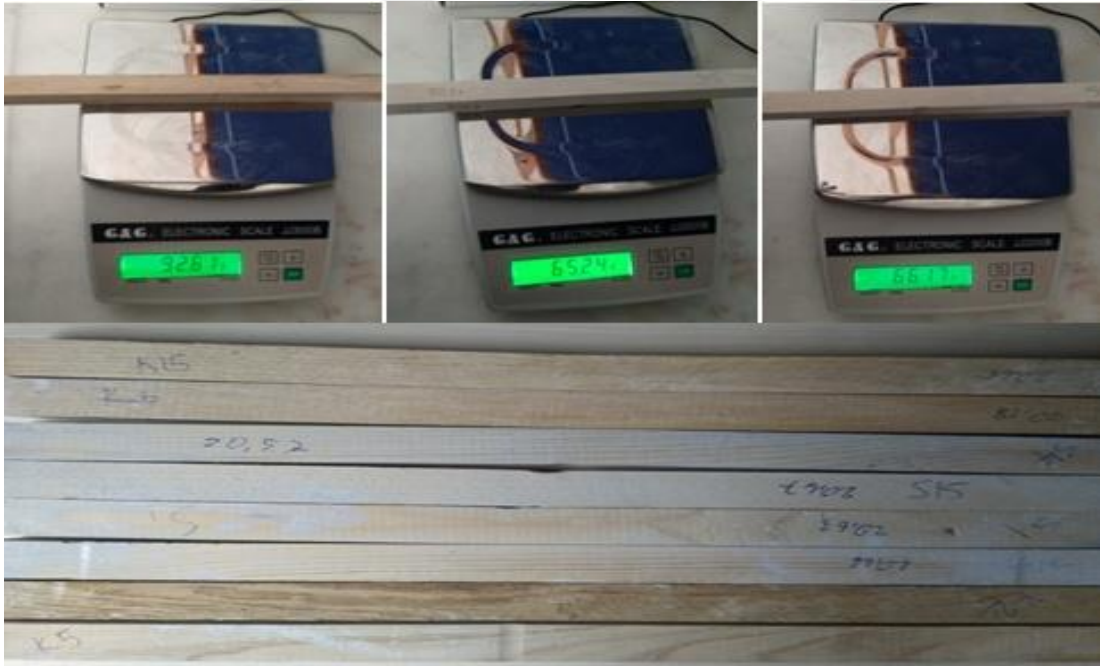
Şekil 2.6. Hava kurusu yoğunluğu deney örneklerinin hassas teraziyle ölçülme anları
