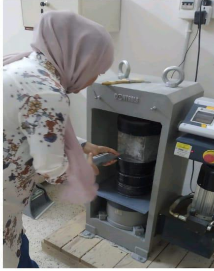
a. Çekici geri tepmesinin yapılması
