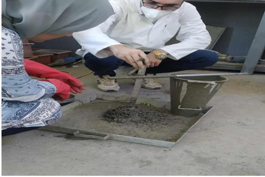
Şekil 5.1 Çökme - slump deneyi uygulamaları ve ölçülmesi
