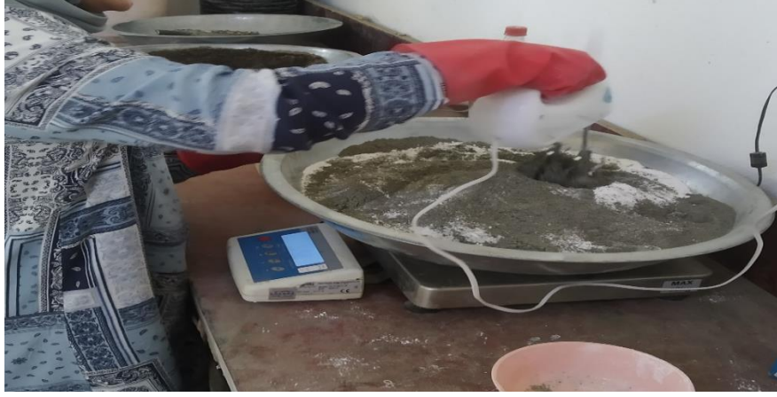
Şekil 4.6 Karışımların elektrikli karıştırıcı ile karıştırılması
