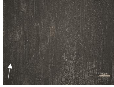
e) %1 nano ZrO 2 katkılı pin yüzeyi
