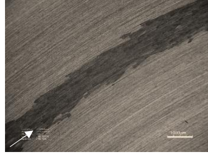
f) %1 nano ZrO 2 katkılı disk yüzeyi
