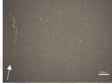
g) %2 nano ZrO 2 katkılı pin yüzeyi
