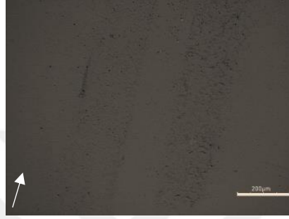
g) %2 nano ZrO 2 katkılı pin yüzeyi
