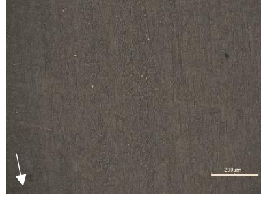
c) %0,5 nano ZrO 2 katkılı pin yüzeyi
