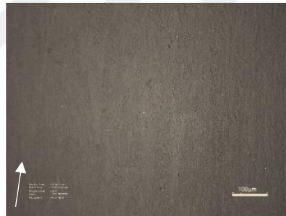
c) %0,5 nano ZrO_2 katkılı pin yüzeyi
