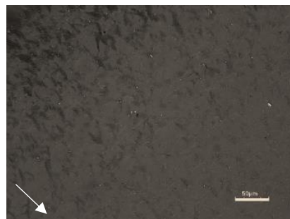
e) %1 nano ZrO_2 katkılı pin yüzeyi
