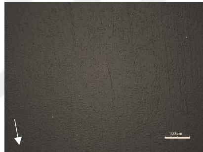
e) %1 nano SiO 2 katkılı pin yüzeyi
