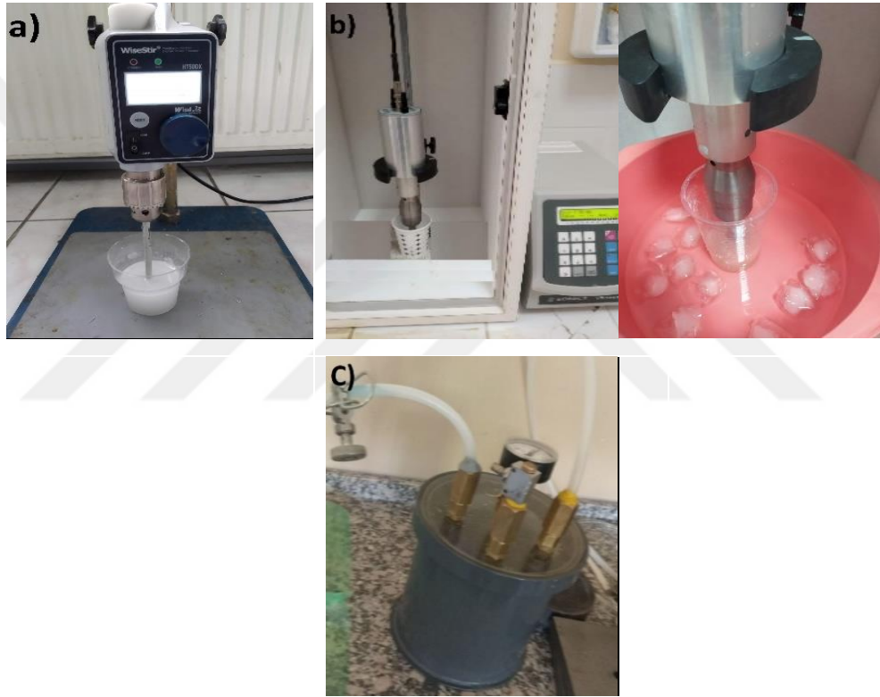
Şekil 2.1. Kompozit hazırlamada kullanılan ekipmanlar a) Mekanik karıştırıcı (WiseStir HT50DX) b) Buzlu su içerisinde ultrasonik karıştırma (Sonics VC750) c) Vakumlama tüpü
