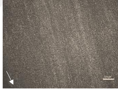
c) %0,5 nano ZrO_2 katkılı pin yüzeyi
