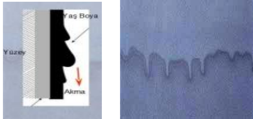
Şekil 2.15. Boyada sakma ve akma hatası kesit görüntüsü (a) yüzey görüntüsü (b) [17].
