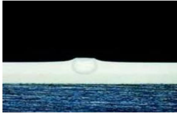
Şekil 2.13. Pinhol kusuru kesit görüntüsü [53].
