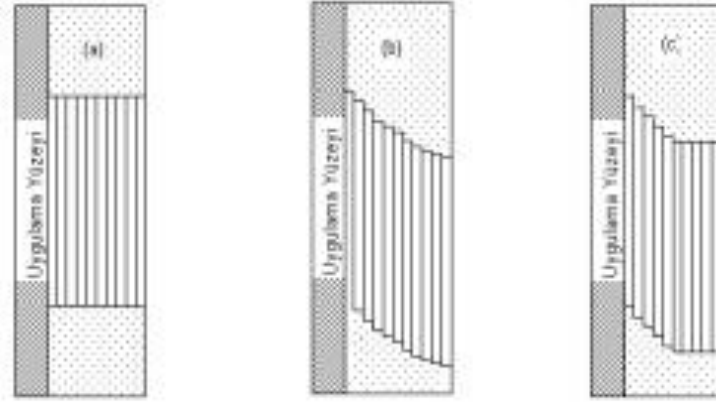
Şekil 2.16. Yüzeye yeni uygulanmış boyanın yüzey görüntüsü (a) uygulamadan bir süre sonra uygulama yüzey görüntüsü (b) akma limitini aşarak akan boya (c) [53].
