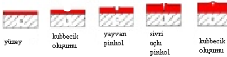
Şekil 2.12. Boya yüzeyinde pinhol oluşumu [53].
