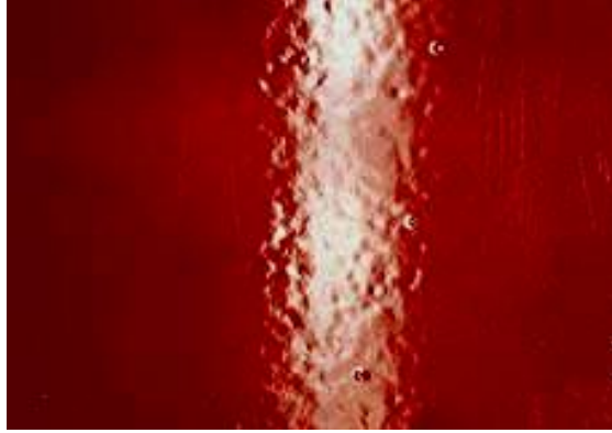
Şekil 2.14. Boyada portakal kabuğu görüntüsü [17].
