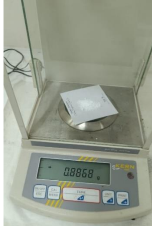
Şekil 3.2. Matris ve takviye olarak kullanılan parçacıkların tartım işlemi
