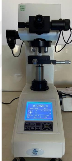
Şekil 3.11. Vickers Sertlik Cihazı
