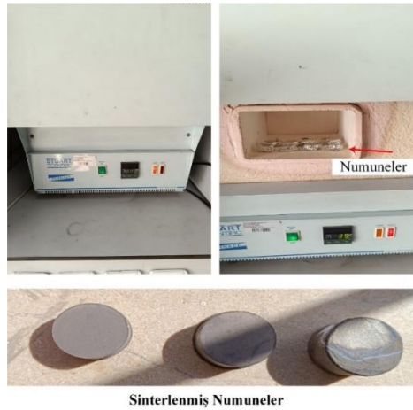
Şekil 3.6. Sinterlemede kullanılan fırın
