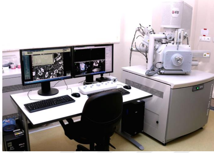
Şekil 3.10. Aşınmış yüzeylerin görüntülenmesinde kullanılan SEM cihazı(Cümerlab, n.d.)
