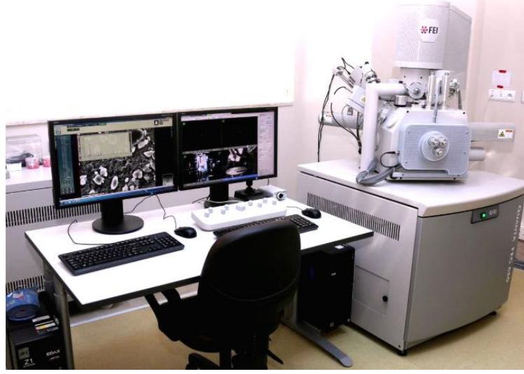
Şekil 3.10. Aşınmış yüzeylerin görüntülenmesinde kullanılan SEM cihazı(Cümerlab, n.d.)
