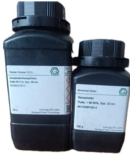
Şekil 3.1. Kullanılan nano \text{TiO}_2 ve \text{ZrO}_2 tozları
