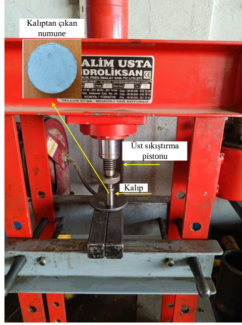
Şekil 3.5. Presleme cihazı ve pres sonrası kalıptan çıkarılan sinterlenmemiş numune
