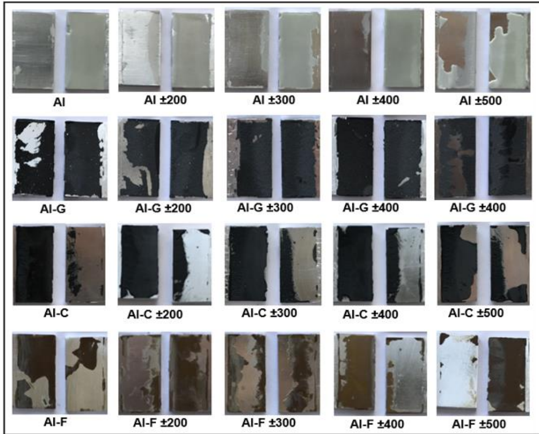
Şekil 4.10. Statik ve tam deęişken drt nokta eęme yorulma ykne maruz alminyum tek tesirli bindirme baęlantıların hasar yzeyleri.
