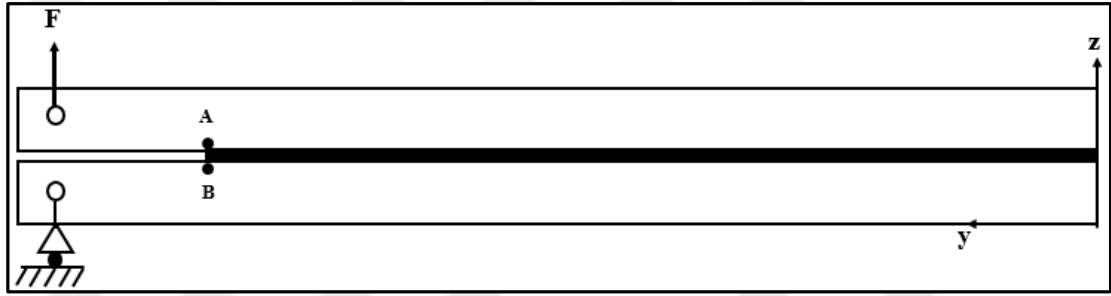
Şekil 1.10. Mod-I ile ayrılma testinin şematik gösterimi
