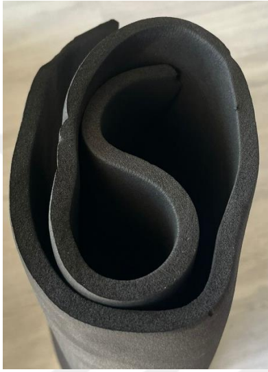
Şekil 3.4. Yalıtım amaçlı kullanılan elastomerik kauçuk köpük malzeme
