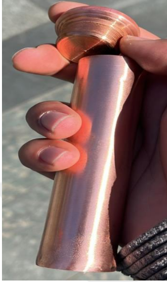
Şekil 3.1. Silindirik bakır test hücresi
