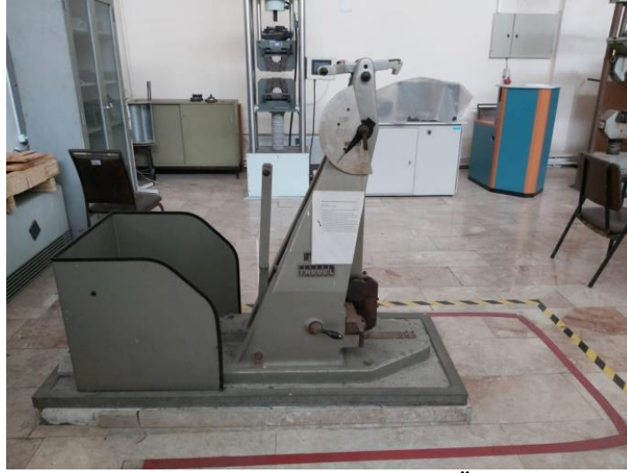
Şekil 15. V-çentik darbe test cihazı (KTÜ Makine Müh. Bölümü)
