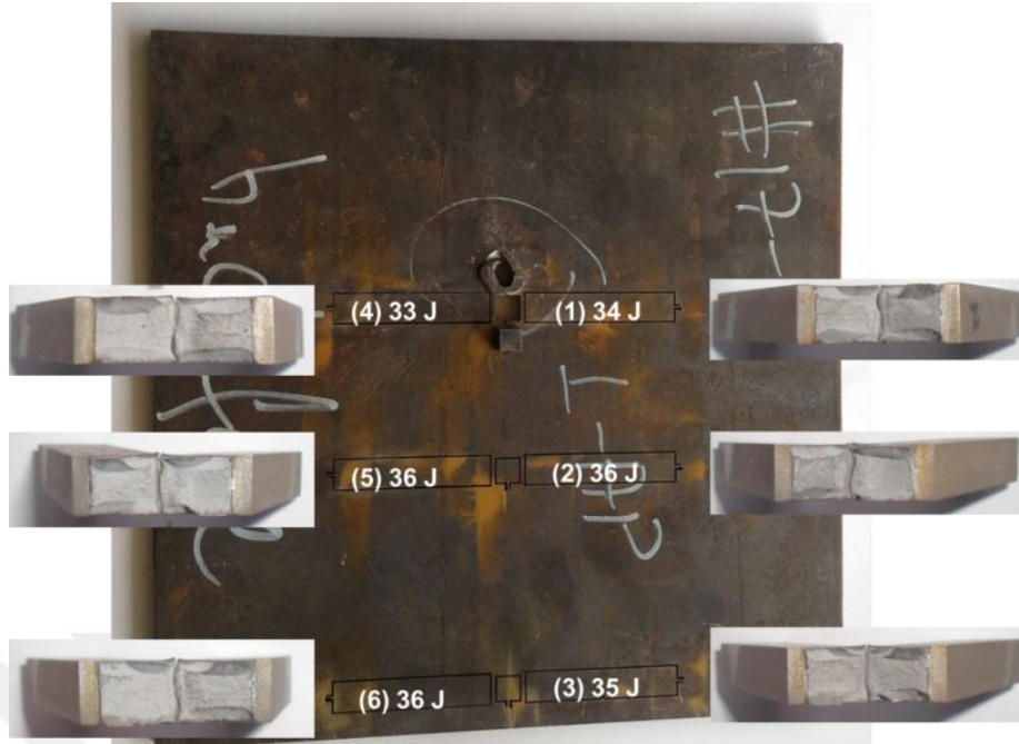
Şekil 31. Çentik darbe testine maruz bırakılan Ramor 500 numunelerinin zırh çeliği plakası üzerinden çıkarıldığı konumlar
