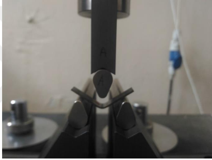
Şekil 17. Çift fazlı otomotiv çeliği numunelerine uygulanan 3-nokta eğilme testi
