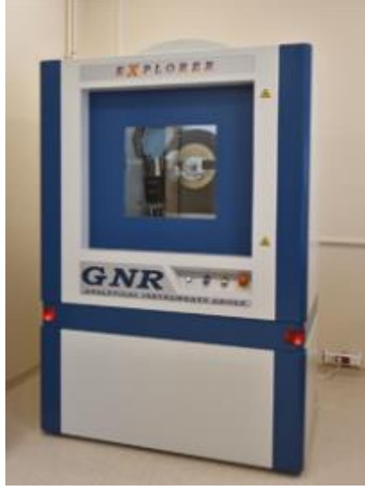
Şekil 20. Artık gerilme ölçümünde kullanılan XRD cihazı (Erzurum Teknik Üniversitesi – YUTAM)
