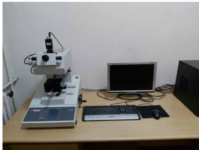
Şekil 16. Mikro Vickers sertlik ölçümleri için Struers Duramin sertlik cihazı (KTÜ Makine Müh. Bölümü)
