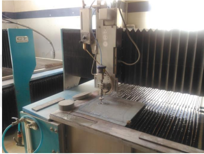
Şekil 14. Numunelerin su jeti tezgahında eldesi (SDT Su Jeti, Ankara)
