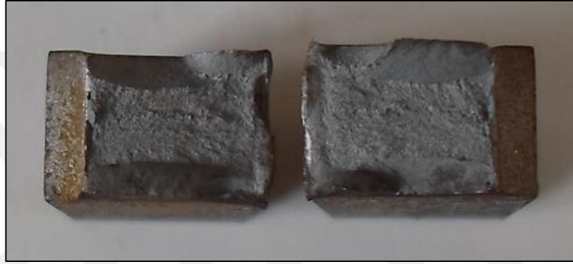
Şekil 30. Charpy V-çentik darbe testine tabi tutulan Ramor 500 numunesinin kırılma yüzey görüntüleri
