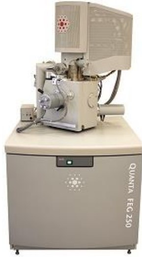
Şekil 19. Numune yüzeylerinin incelenmesinde kullanılan tipik bir tarama elektron mikroskobu (Erzurum Teknik Üniversitesi – YUTAM)
