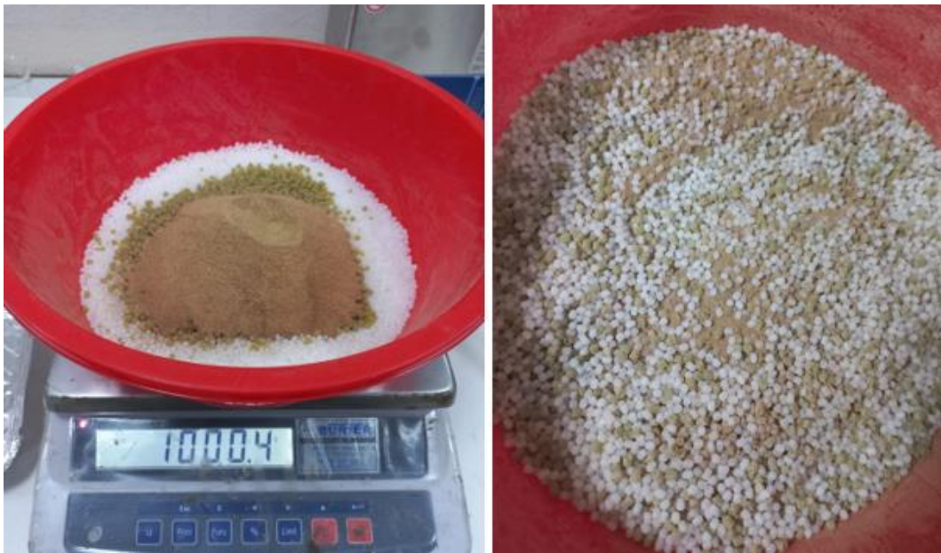
Şekil 2.8. Karışımların hazırlanması ve mekanik harmanlama işlemi
