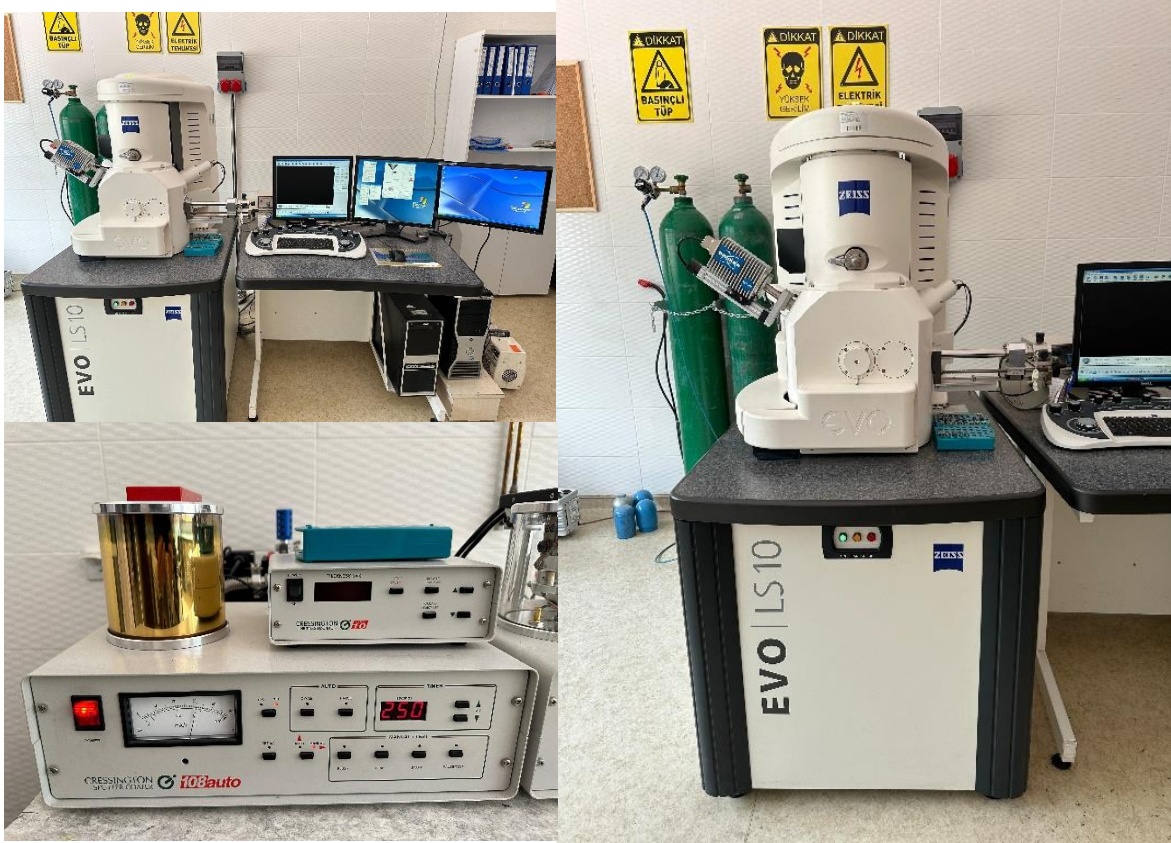
Şekil 2.17. Çalışmada kullanılan altın kaplama ve SEM cihazı
