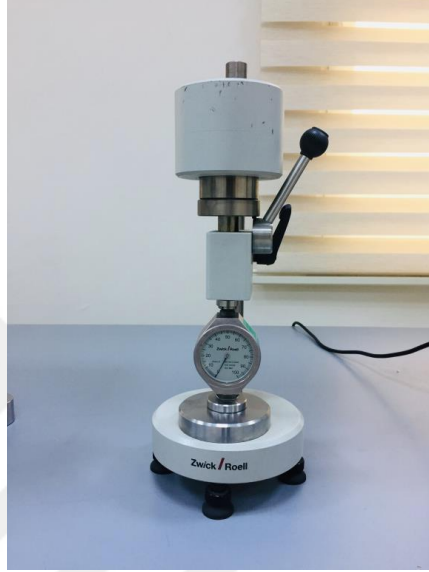
Şekil 2.14. Sertlik ölçümünde kullanılacak olan Zwick/Roell marka sertlik ölçüm cihazı
