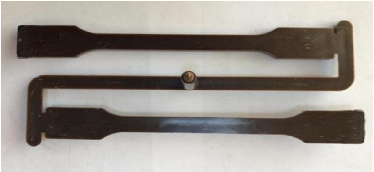
Şekil 2.11. Enjeksiyon kalıplama sonrasında elde edilen numunelerin görünümü
