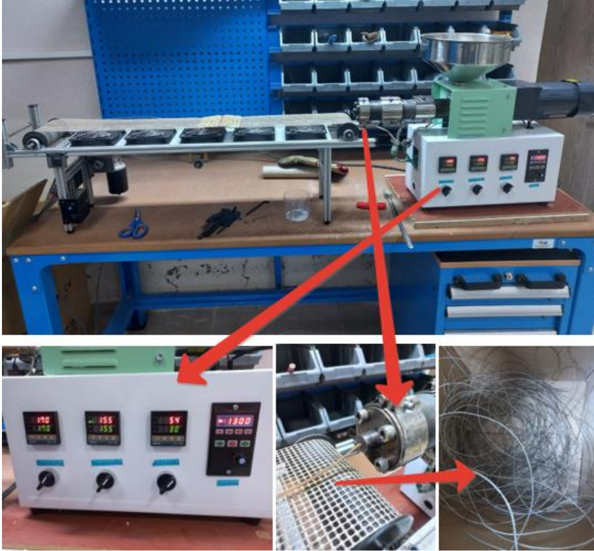
Şekil 2.9. Karışımların ekstrüderde hazırlanması ve filament şekline getirilmesi
