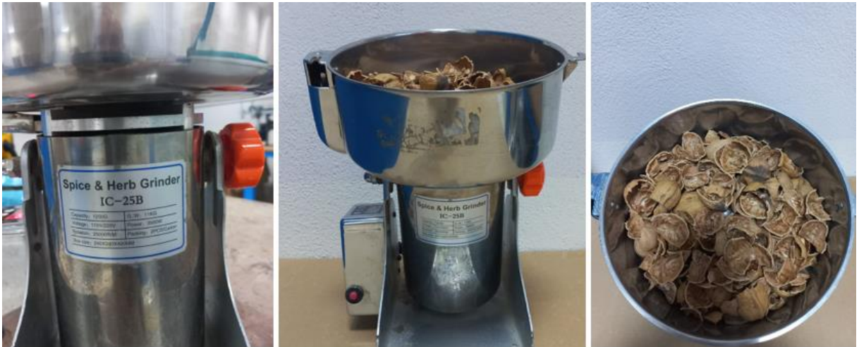
Şekil 2.5. Ceviz kabuklarını öğütmek için kullanılan hububat öğütücüsü
