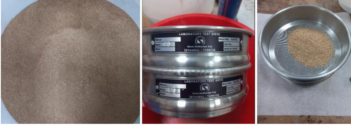
Şekil 2.6. Öğütülmüş ceviz kabuğu ve kullanılan elekler
