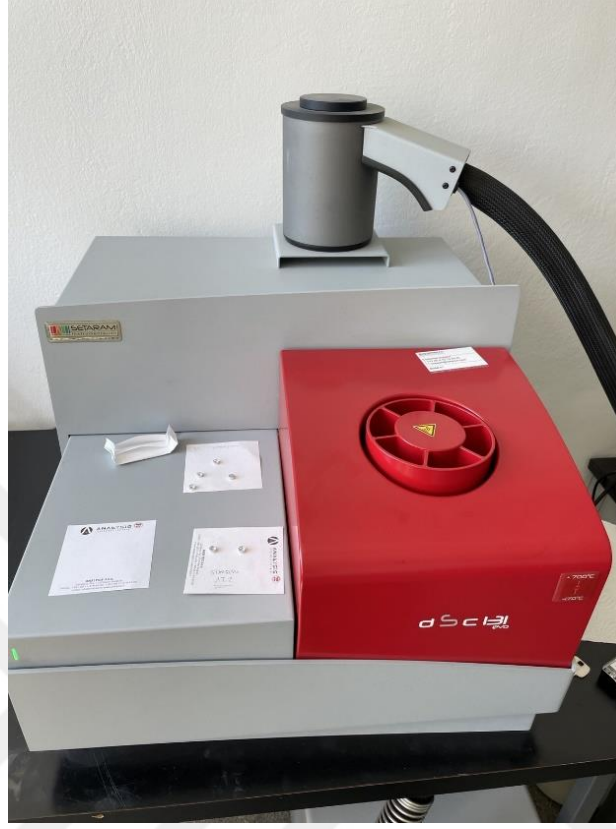
Şekil 2.15. Çalışmada kullanılan DSC cihazı
