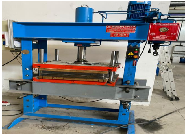
Şekil 6.6 üst üste konulmuş plakalara sıcak presleme uygulanması
