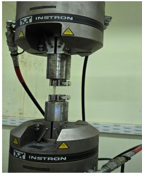
Şekil 6.14 Instron marka test cihazı ve basma testinin yapılışı
