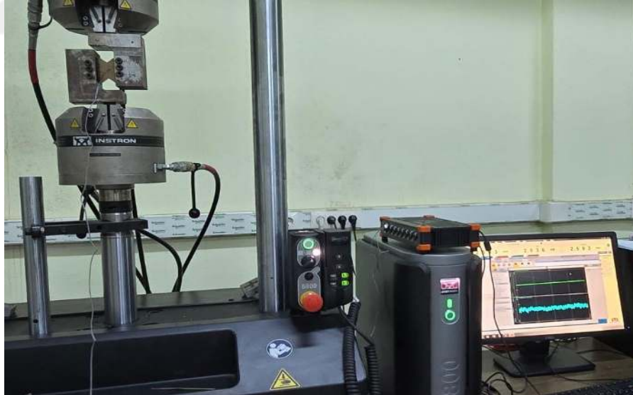
Şekil 6.17 Instron marka test cihazı ile kayma testinin yapılışı
