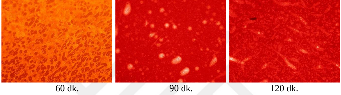
Şekil 29. 160 °C’de 4000 dev./dk.’da hazırlanan SBS PMAN optik mikroskop görüntüleri
