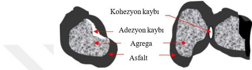
Şekil 3. Asfalt aşınma tabakasındaki kohezyon ve adezyon kaybı nedeniyle oluşan soyulma (Das vd., 2015).
