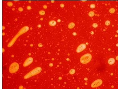
Şekil 27. SBS modifiye bitüm optik mikroskop görüntüsü
