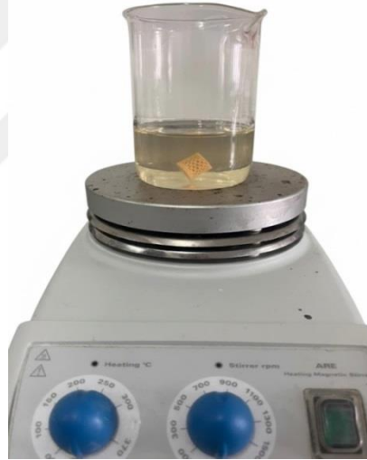
Şekil 25. Daldırma yöntemiyle lattice greftlere kitosan kaplama işleminin uygulanması.
