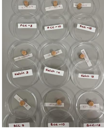
Şekil 26. Kitosan kaplama işlemi yapılan lattice greftler.
