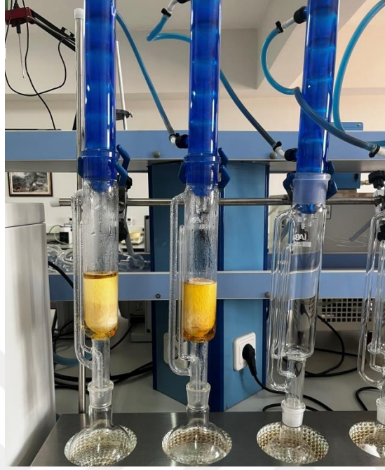
Şekil 12. Soxhlet cihazı kullanılarak gerçekleştirilen ekstraksiyon işlemi.
