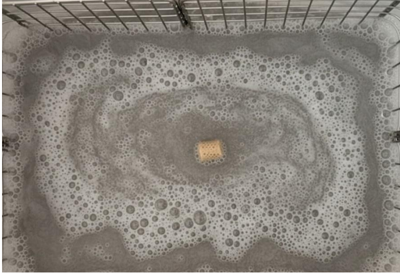
Şekil 18. Selüloz katkılı lattice greftlerin ultrasonik banyoda temizlenme işlemi.
