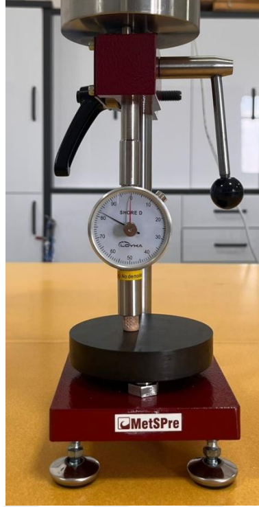
Şekil 23. Lattice greftlerin Shore D yöntemiyle sertlik ölçümleri.
