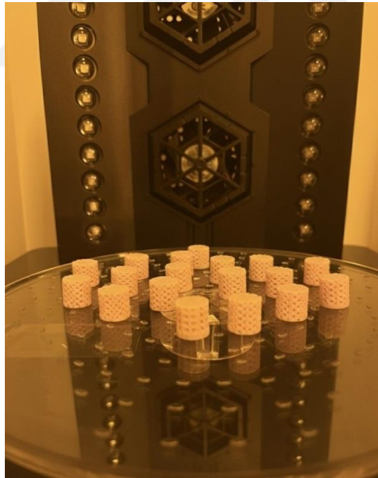
Şekil 19. Selüloz katkılı lattice greft modellerine UV ışık altında son kürleme işlemi uygulanması.
