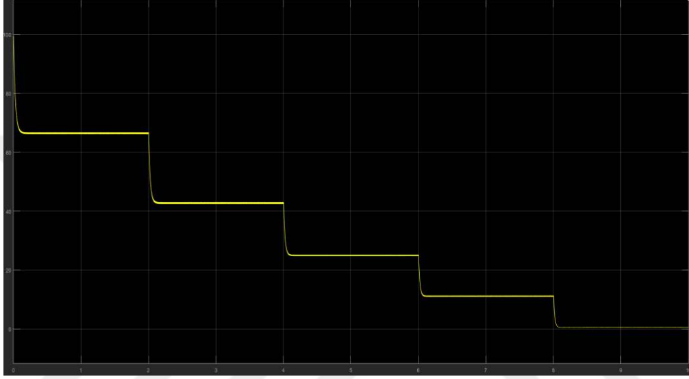
Şekil 4.7 Filtreleme sonrası Farklı görev sürelerindeki çıkış voltajı
