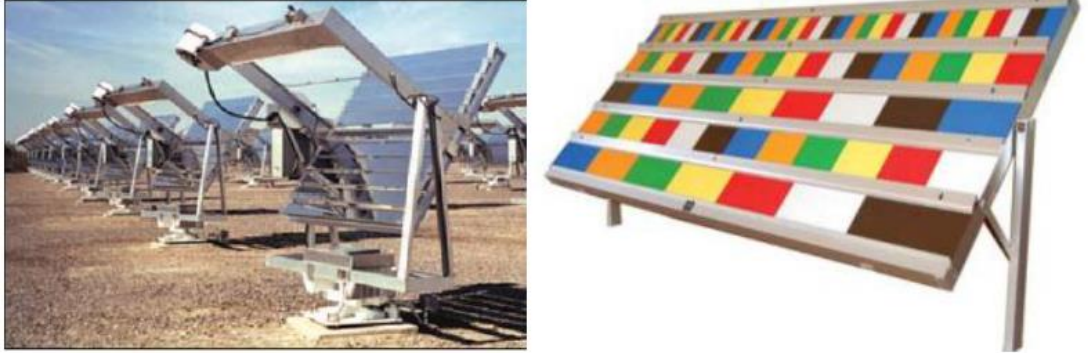
Şekil 2.11 Dış ortamda güneş ışınının ayna ile parça üzerine yansımaları (Ulay, 2018)
