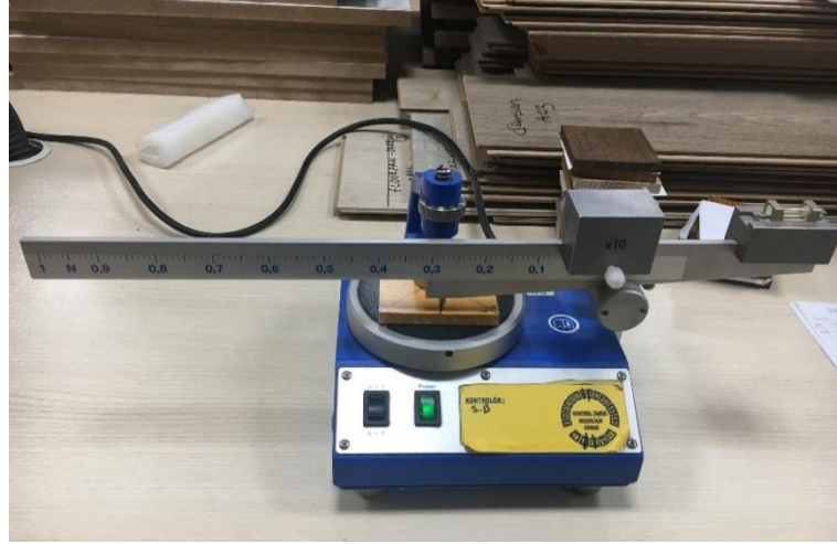
Fotoğraf 4.5 Çizilme direnci ölçüm cihazı
