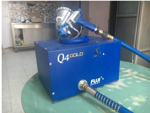
Fotoğraf 3.4 Fuji Spray Q4 Gold boya/vernik makinesi
