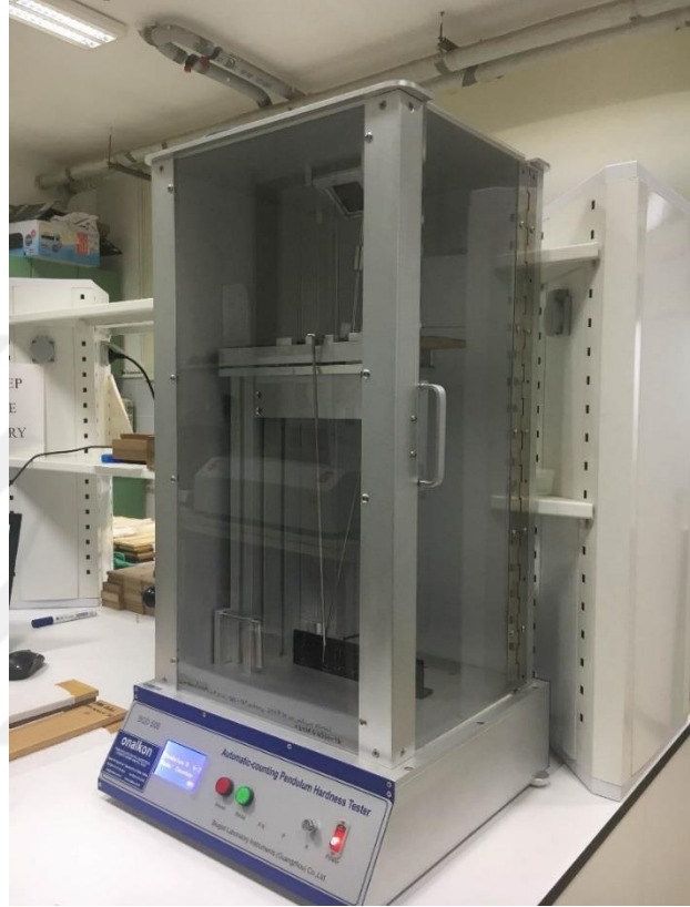
Fotoğraf 4.3 Salınımsal sertlik ölçüm cihazı
