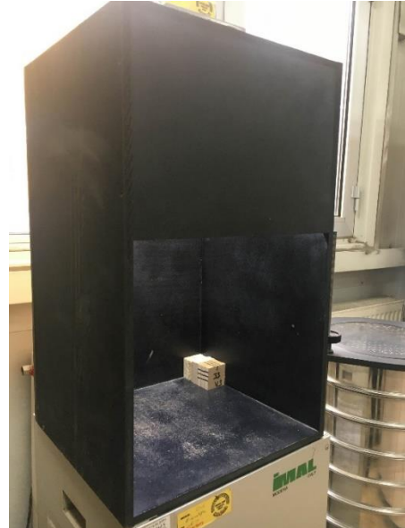
Fotoğraf 4.6 Örnek yüzeylerinin incelendiği görüntüleme kabini
