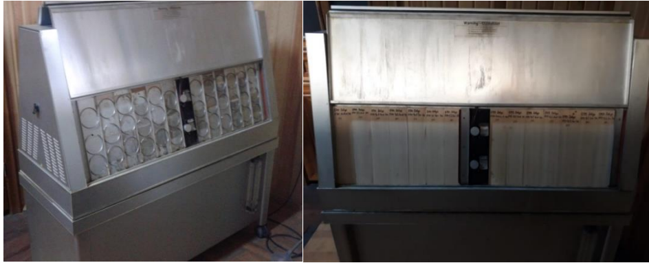
Fotoğraf 3.5 Hızlandırılmış yaşlandırma test cihazı
