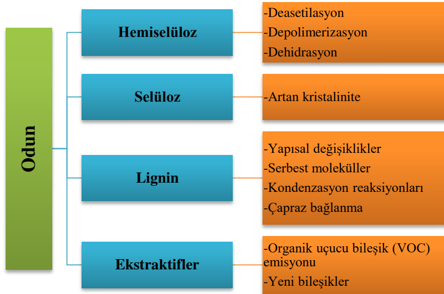
Şekil 2.5 Isıl işlem sürecinde odunun ana bileşenlerinde meydana gelen kimyasal değişimler (Gürleyen, 2018)
