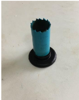
Fotoğraf 4.8 Çekme silindiri çevresi temizleme aparatı
