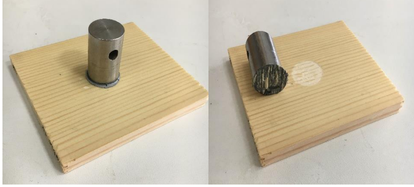
Fotoğraf 4.9 Yapıştırılmış ve koparılmış deney örneği
