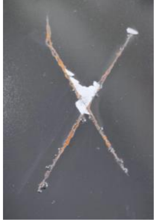
Şekil 117. İki pas atım ile 60 mikron kalınlıktaki a) Referans boya b) Silika içerikli boyalı plakaların bant çekiş sonrası 350 saatlik tuz testi görselleri
