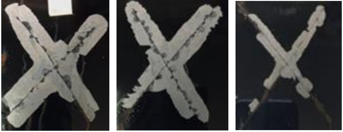
Şekil 122. Referans boya ile a)30 mikron, b)60 mikron, c)100 mikron kuru film kalınlığındaki uygulanan boyalı plakanın 350 saatlik tuz testi ve bant çekilmiş görselleri
