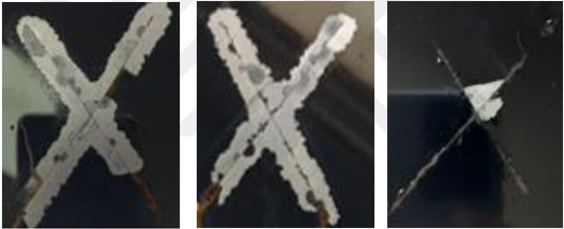
Şekil 123. BN içerikli boya ile a) 30 mikron, b) 60 mikron, c)100 mikron kuru film kalınlığındaki uygulanan boyalı plakanın 350 saatlik tuz testi ve bant çekilmiş görselleri
