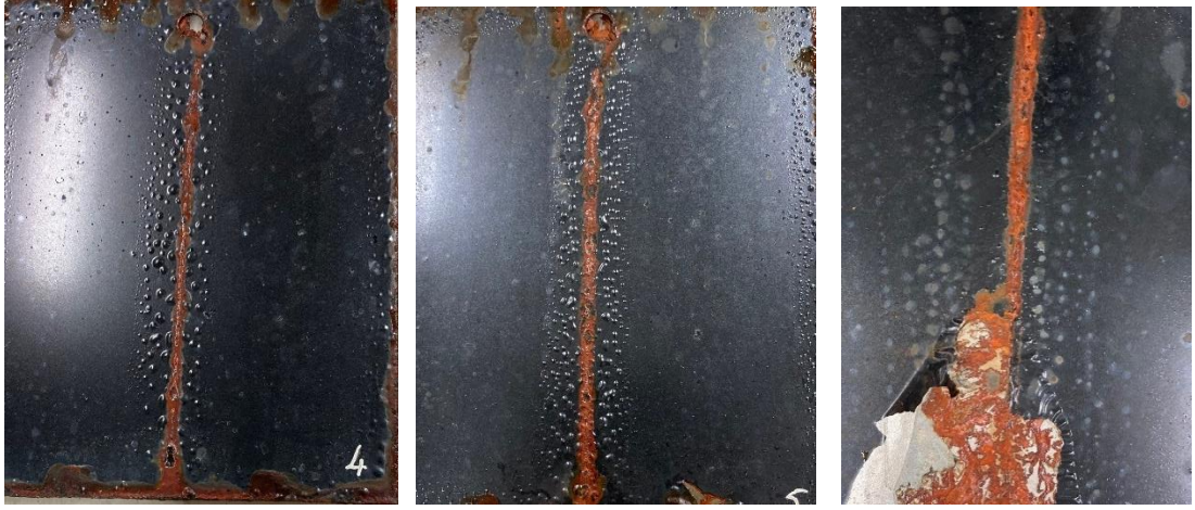
Şekil 128. Referans boya plakaların a) 30 mikron b) 60 mikron c) 100 mikron kalınlıklardaki 120 saatlik Cass test sonuçları
