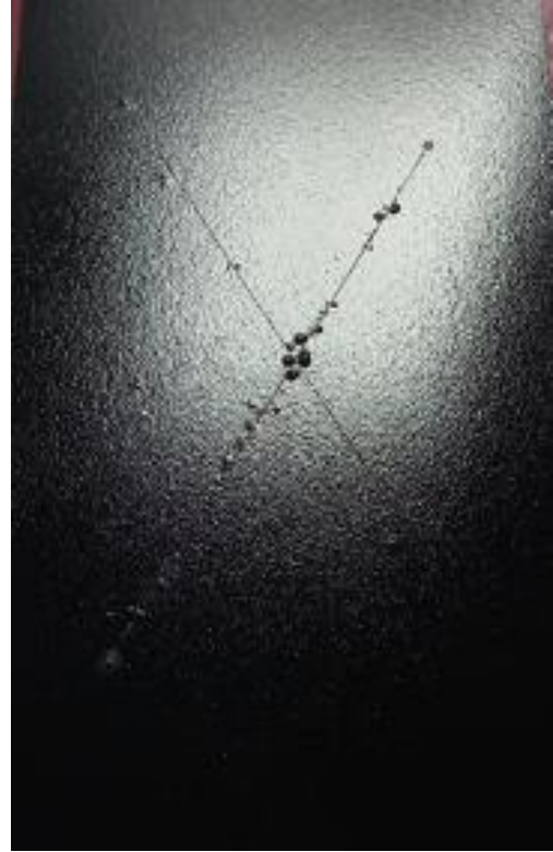
Şekil 113. Üç pas atım ile 100 mikron kalınlıktaki a) Referans boya b) Silika içerikli boyalı plakanın 250 saatlik tuz testi görselleri
