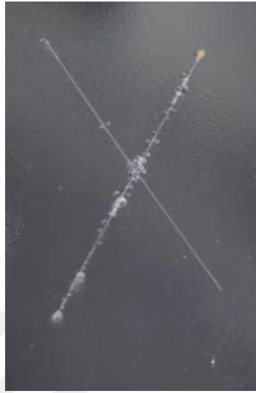
Şekil 118. Üç pas atım ile 100 mikron kalınlıktaki a) Referans boya b) Silika içerikli boyalı plakanın 350 saatlik tuz testi görselleri
