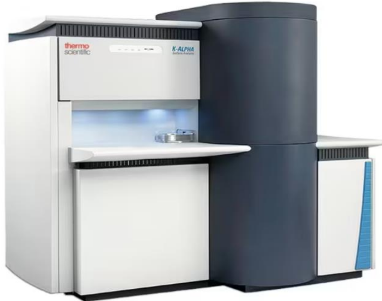
Şekil 31. X-ışını Fotoelektron Spektroskopisi (XPS) Cihazı
