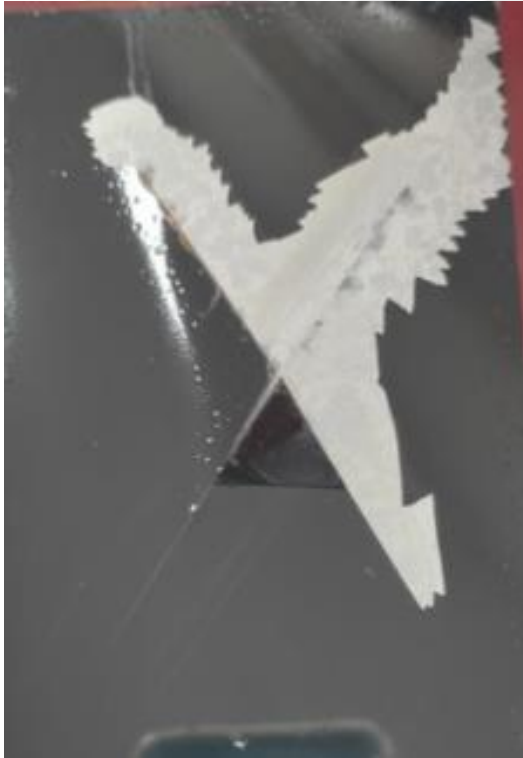
Şekil 119. Üç pas atım ile 100 mikron kalınlıktaki a) Referans boya b) Silika içerikli boyalı plakaların bant çekiş sonrası 350 saatlik tuz testi görselleri
