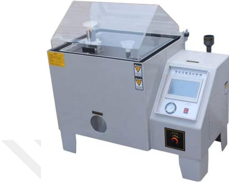
Şekil 38. CASS ve Salt Sprey Test Kabini
