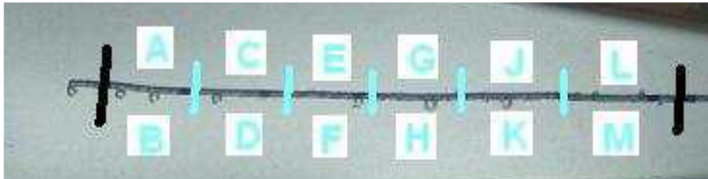
Şekil 39. Cass testi uygulanan bir kaplama örneği
