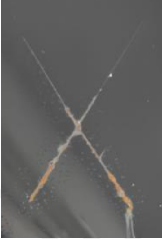
Şekil 118. Üç pas atım ile 100 mikron kalınlıktaki a) Referans boya b) Silika içerikli boyalı plakanın 350 saatlik tuz testi görselleri
