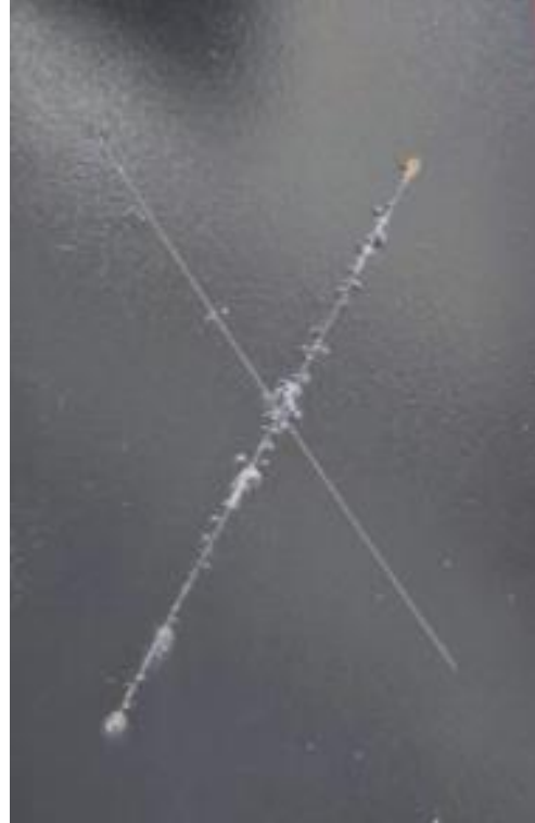
Şekil 119. Üç pas atım ile 100 mikron kalınlıktaki a) Referans boya b) Silika içerikli boyalı plakaların bant çekiş sonrası 350 saatlik tuz testi görselleri
