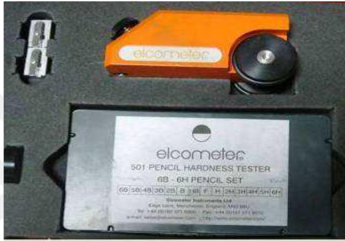
Şekil 40. Kalem sertliđi test yönteminde kullanılan ekipman
