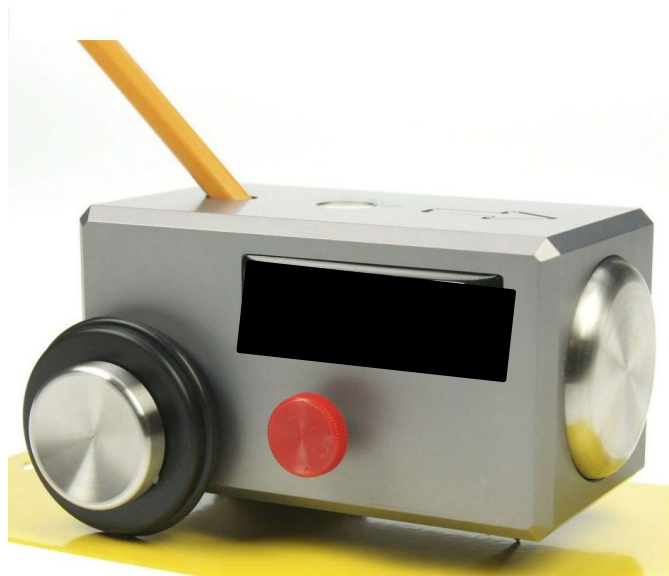
Şekil 41. Kalem sertliđi test kullanım biçimi
