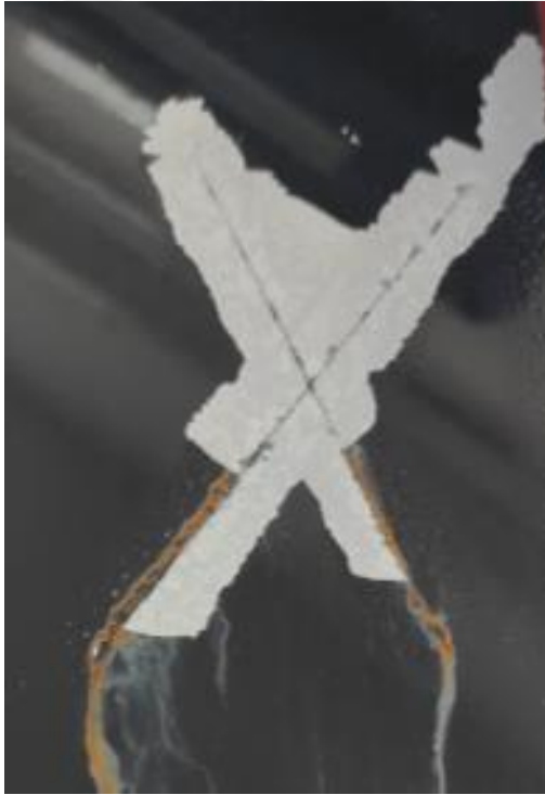
Şekil 117. İki pas atım ile 60 mikron kalınlıktaki a) Referans boya b) Silika içerikli boyalı plakaların bant çekiş sonrası 350 saatlik tuz testi görselleri
