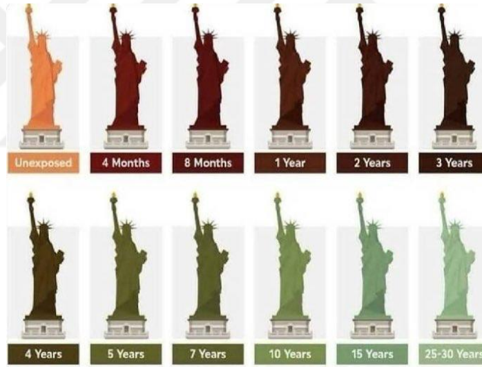
Şekil 3. Zaman ve ortam koşullarına bağlı meydana gelen korozyon değişimi [6]
