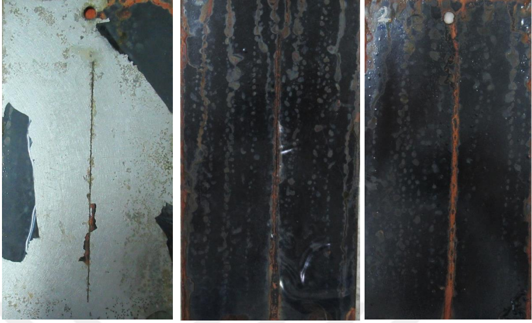
Şekil 132. Referans boya plakaların a) 30 mikron b) 60 mikron c) 100 mikron kalınlıklardaki 240 saatlik Cass test sonuçları
