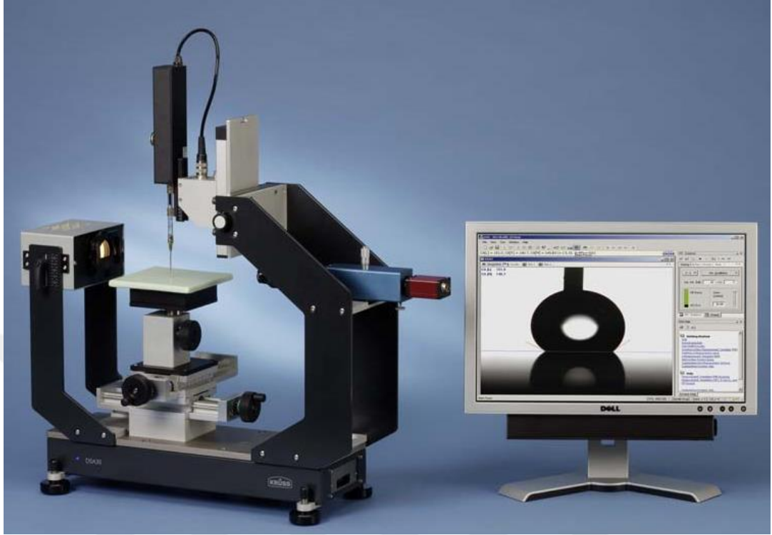
Şekil 33. Krüss DSA100 Gonyometre
