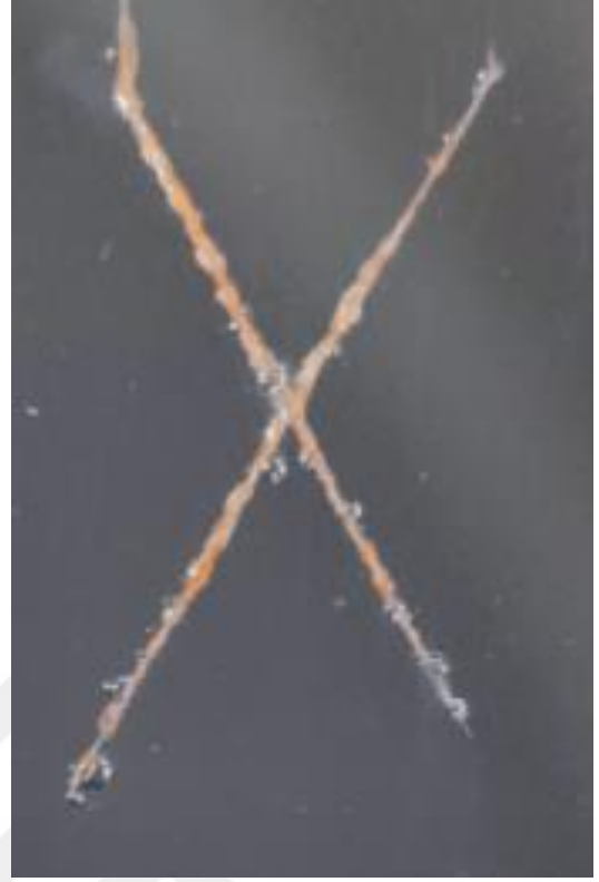
Şekil 116. İki pas atım ile 60 mikron kalınlıktaki a) Referans boya b) Silika içerikli boyalı plakanın 350 saatlik tuz testi görselleri
