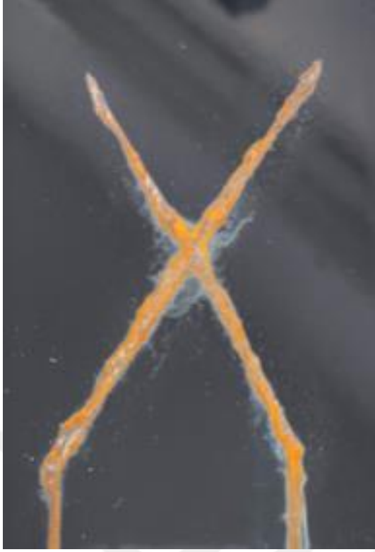
Şekil 112. İki pas atım ile 60 mikron kalınlıktaki a) Referans boya b) Silika içerikli boyalı plakanın 250 saatlik tuz testi görselleri
