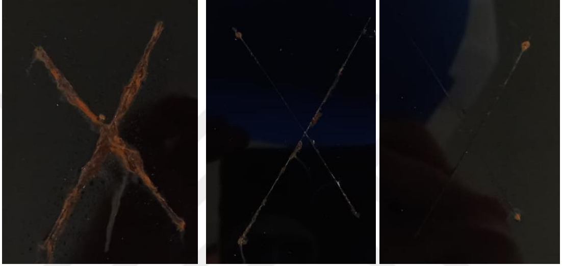
Şekil 124. ZnO içerikli boya ile a) 30 mikron, b) 60 mikron, c) 100 mikron kuru film kalınlığındaki uygulanan boyalı plakanın 350 saatlik tuz testi sonucu görselleri
