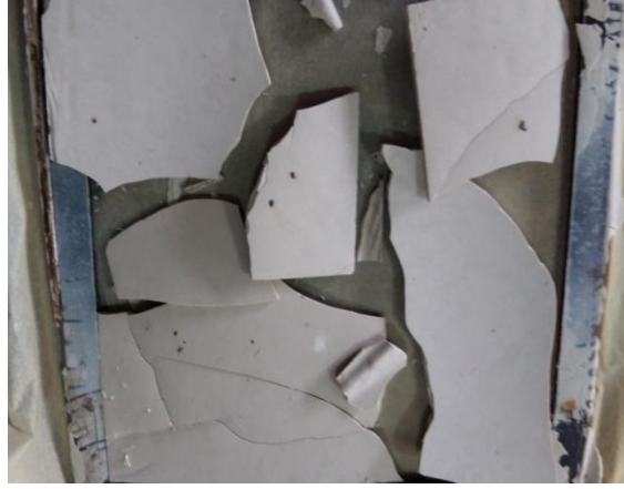
Şekil 44: Soğuk pres sonrası kırılan PHB biyokompoziti.
