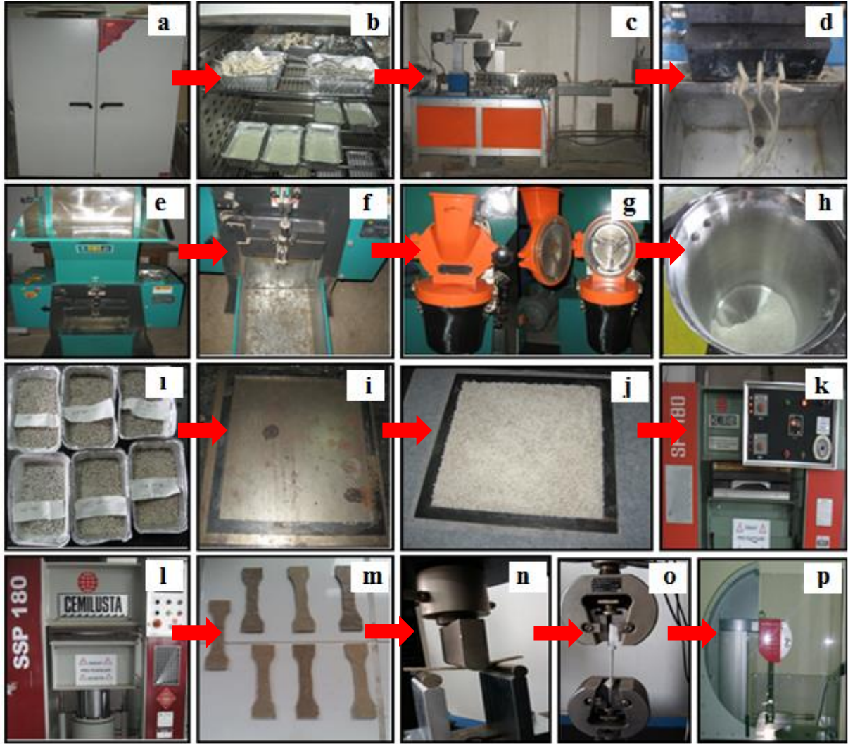
Şekil 43: Örnek hazırlama aşamaları: Örnek hazırlama aşamaları: (a) örneklerin kurutulmasında kullanılan etüv, (b) ekstrüderden geçirilmiş örnekler ve peletler, (c) örneklerin hazırlanmasında kullanılan ekstrüder, (d) ekstrüder çıkışı, (e,f) plastik kırma makinesi, (g,h) lif öğütücü, (i) plastik yongalayıcıdan geçirilmiş plastik yongaları, (j) yongaların preslenmesinde kullanılan kalıplar, (k) sıcak pres, (l) soğuk pres, (m) çekme numuneleri, (n) eğilme deneyi, (o) çekme deneyi, (p) çentikli şok direnci deneyi.
