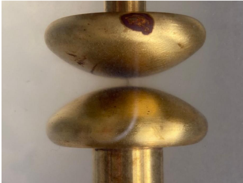
Şekil 3.6. Yağın konsantrasyon oranına bağlı deşarj yolunun görüntüsü.
