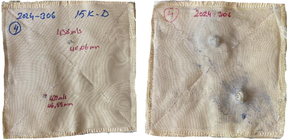
Resim 4.2: 15 Kat Epoksisiz Aramid Plakanın Atış Sonrası Ön ve Arka Yüzeyi
