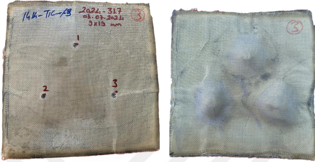
Resim 4.5: 14 Katlı %3 TiC Katkılı Epoksi Reçineli Plakanın Atış Sonrası Ön ve Arka Yüzeyi
