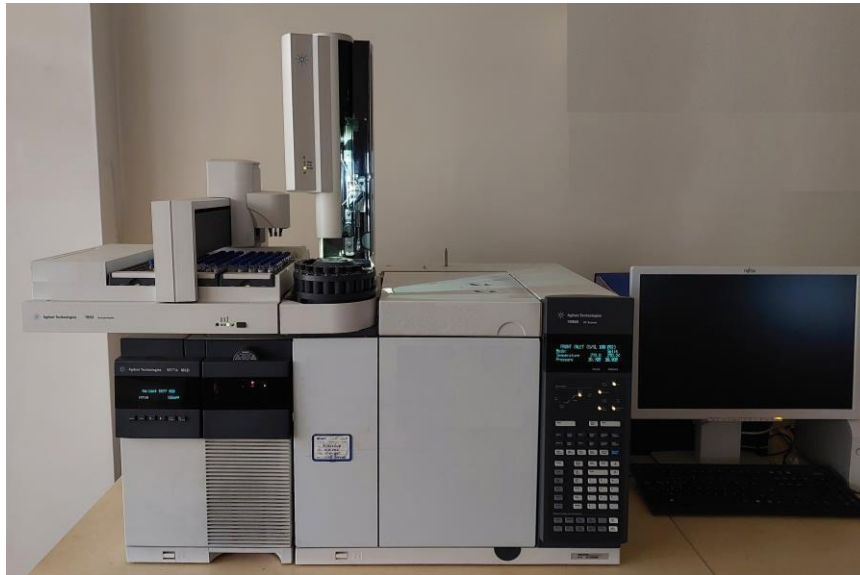
Şekil 3.2 Agilent 7890B GC-5977A MSD GC-MS Cihazı
