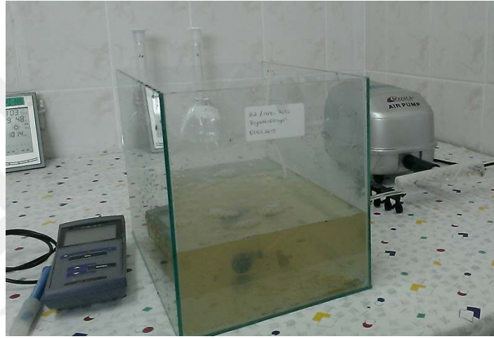
Şekil 3.6 Biyoakümülayon testi deney düzeneği
