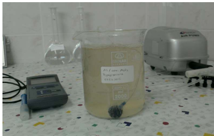
Şekil 3.4 Biyoayrışabilirlik testi deney düzeneği
