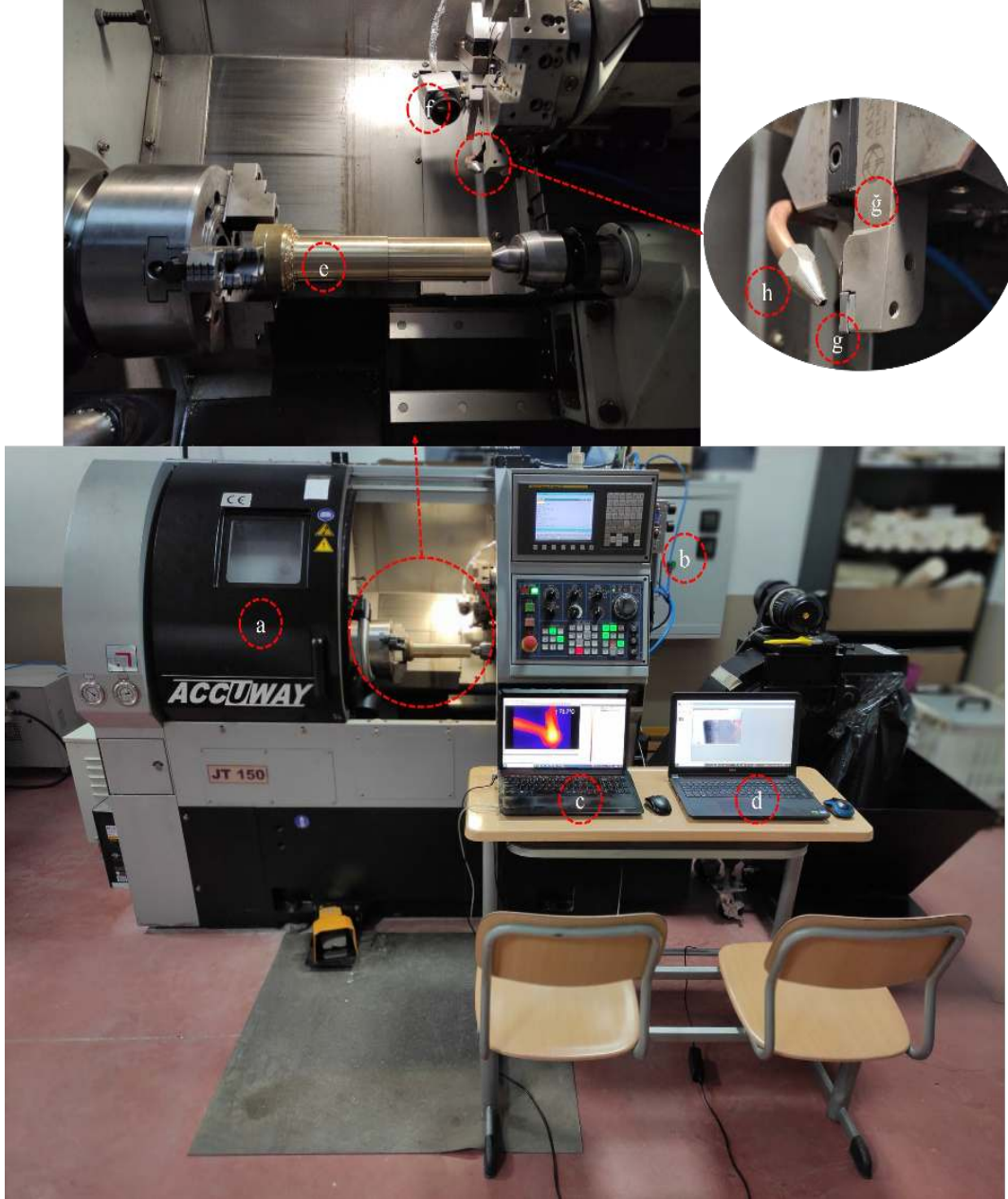
Şekil 6.14. Deney düzeneği a) CNC torna tezgahı b) MQL sistemi c) Termal sıcaklık programı d) Dijital mikroskop programı e) Deney numunesi f) Termal kamera g) Kesici takım ğ) Kesici takım tutucu h) MQL nozulu.
