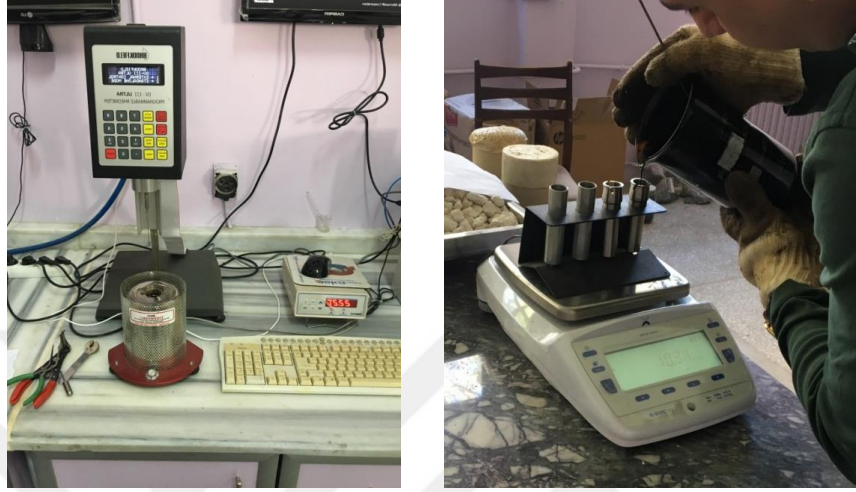
Şekil 2.12. Brookfield Viskozimetre ve Deney Tüpleri
