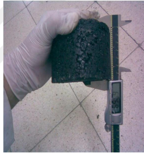
Şekil 4.23. Numunelerin Krikoyla Çıkarılması (a) ve Kumpasla Yüksekliğin Ölçülmesi (b)
