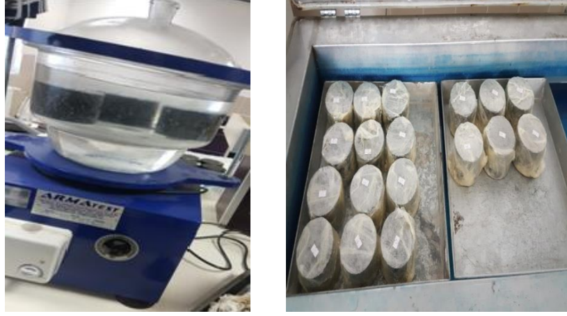
Şekil 4.36. Numunelere Vakum Uygulanması (a), Streç Film ile Sarılması (b)
