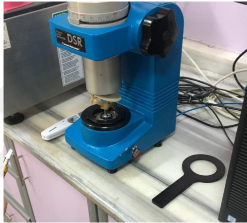
Şekil 2.16. Bohlin DSR II Dinamik Kesme Reometresi
