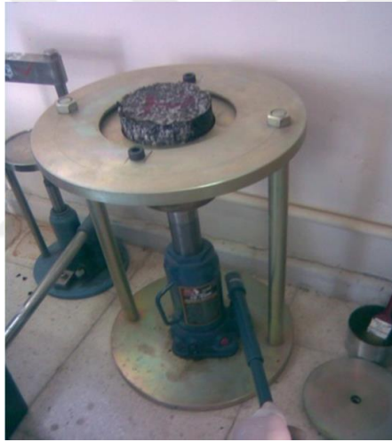
Şekil 4.23. Numunelerin Krikoyla Çıkarılması (a) ve Kumpasla Yüksekliğin Ölçülmesi (b)
