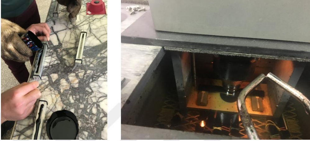
Şekil 2.14. BBR Deneyi İçin Numune Hazırlanması (a) ve Deneyin Yapılması (b)
