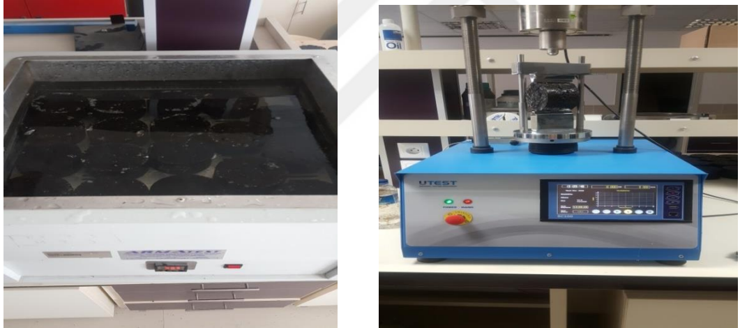
Şekil 4.37. Numunelerin 60°C Su Banyosunda Bekletilmesi (a) ve Kırılması (b)
