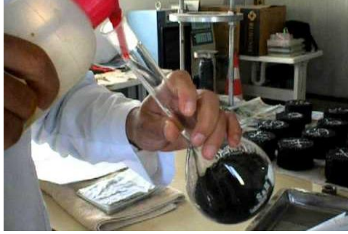
Şekil 2.9. Piknometre Kabı ile Özgül Ağırlık Tayini
