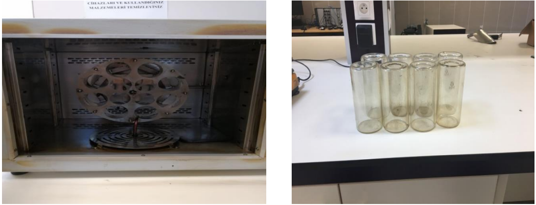
Şekil 2.10. RTFOT Cihazı (a) ve Deney Şişeleri (b)
