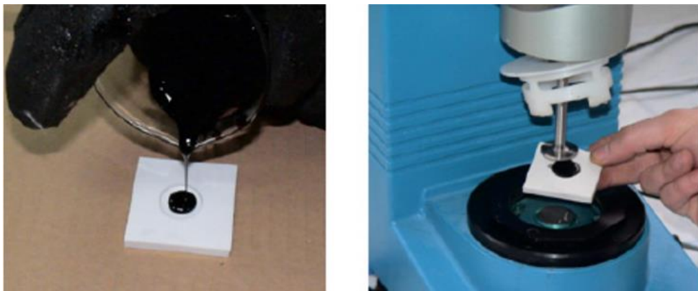
Şekil 2.17. Numunenin Silikon Kalıba Doldurulması (a) ve Üst Plağa Yerleştirilmesi (b)
