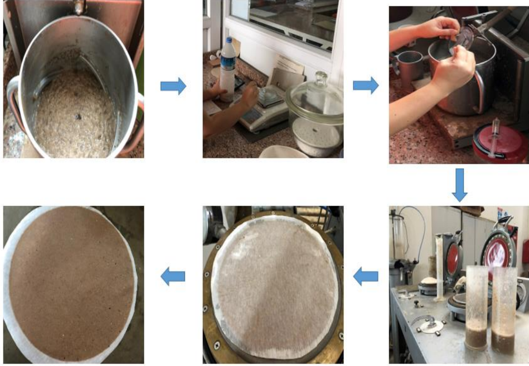
Şekil 2.3. CNF/CNF-OX katkılı fluting kağıdı/gri ve mihver karton üretimi laboratuvar denemeleri.
