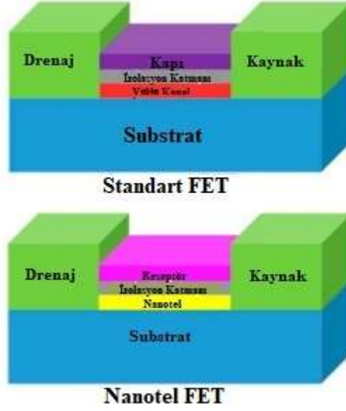
Şekil 3.10. Nanotel ve standart FET yapı farklılıklarının şematiği (14).
